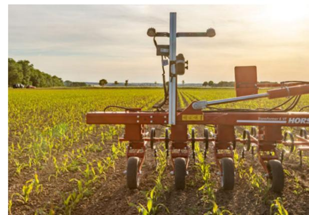
Hochpräzise Steuerung an der Pflanzenreihe entlang durch die optionale Kamera Culticam
