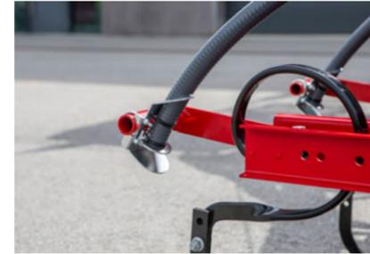
Prallblechschiene in Kombination mit MiniDrill z.B. für Untersaaten
