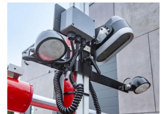
Kamerasteuerung Culticam mit optionalem Lichtpaket für Arbeiten bei Dämmerung oder Dunkelheit
