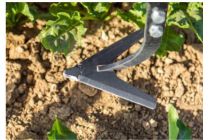
Höhere Standzeiten durch die mit Hartmetall verstärkten EdgeOn Schare
