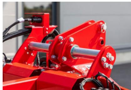
Robust dimensionierter Verschieberahmen mit 450 mm Verschiebeweg
