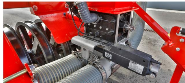
Mit einer SectionControl Freischaltung kann die elektrische Halbseitenabschaltung automatisiert werden.
