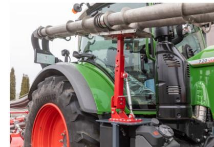
Halterungskit für Pneumatikverrohrung
