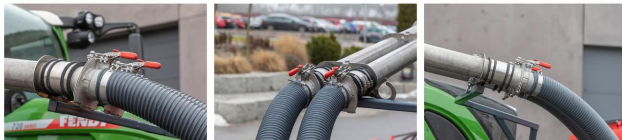
Einfaches und werkzeugloses Handling der Pneumatikverrohrung
