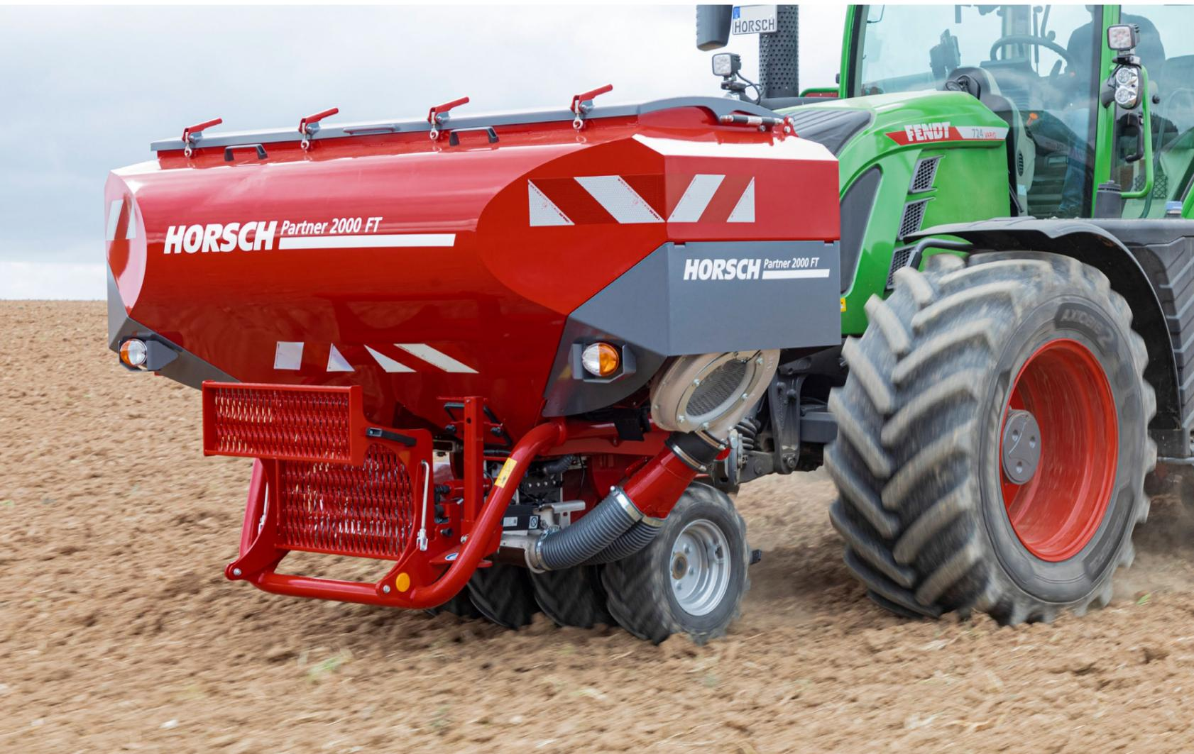
Der Partner 2000 FT ist als Doppeltank ausgeführt und fasst insgesamt 2 200 l. Je nach Einsatzzweck stehen 2 Grundvarianten zur Verfügung:
