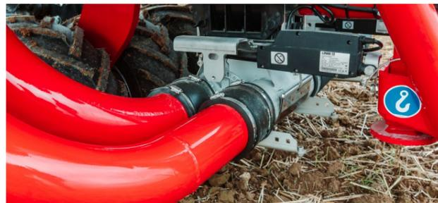
Elektrische Halbseitenabschaltung – einfaches Ein- und Ausschalten der Halbseite über Knopfdruck im Terminal
