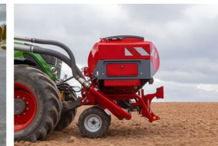
Der Reifenpacker ermöglicht das Andrücken und Zerkleinern von Kluten
