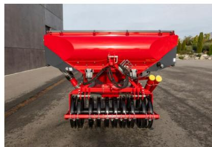
Der RollPack Packer sorgt für eine tiefgehende, streifenweise Rückverfestigung
