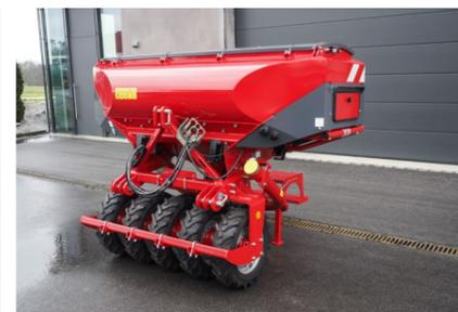
Der Reifenpacker garantiert eine gleichmäßige Rückverfestigung in inhomogenen Bedingungen
