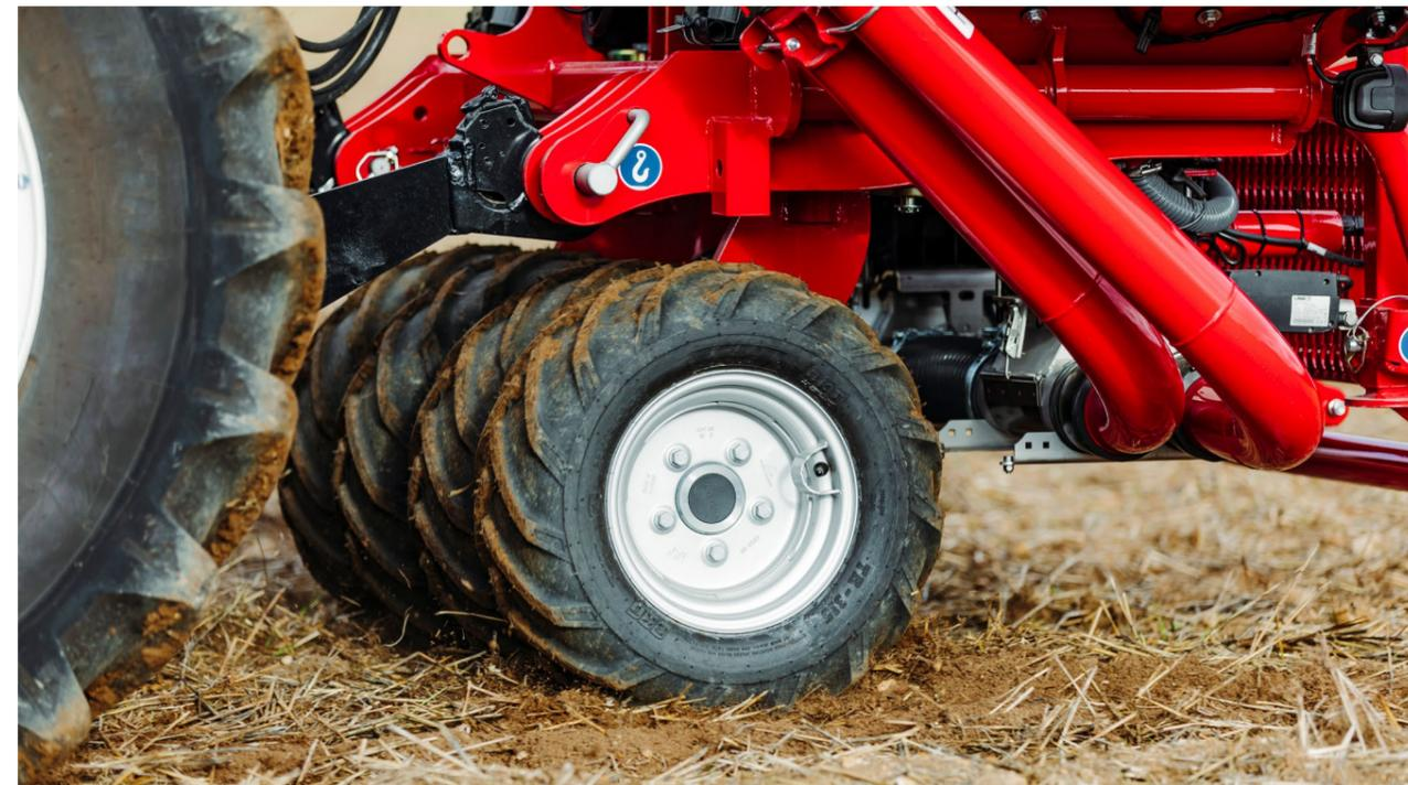
Der Reifenpacker ermöglicht im Feldeinsatz eine optimale Bodenschonung
