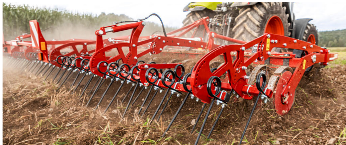
Optional mit hydraulisch verstellbarem Doppelstriegel
