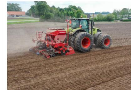
Der Doppeltank G&F ermöglicht es, zwei Komponenten getrennt zu dosieren und auf einem Horizont abzulegen.
