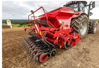
Hydraulische Sätiefenverstellung mit Clips
