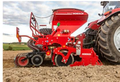
Beim Vorkreiseln am Vorgewende kann die Säschiene hydraulisch ausgehoben werden.
