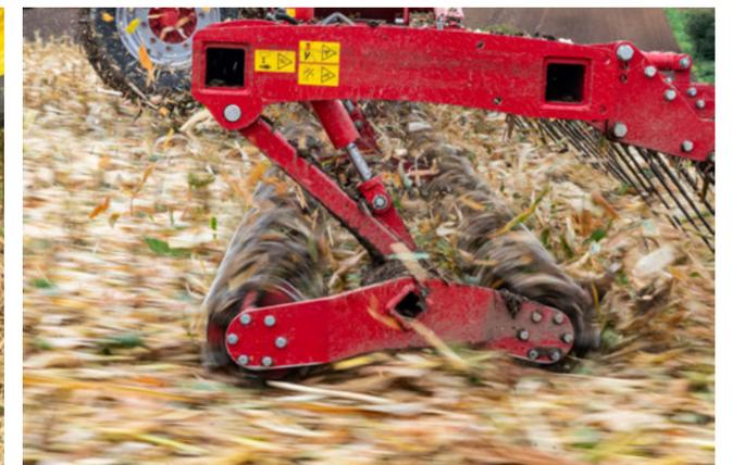
Doppelmesserwalze mit einer theoretischen Schnittlänge von 14 cm
