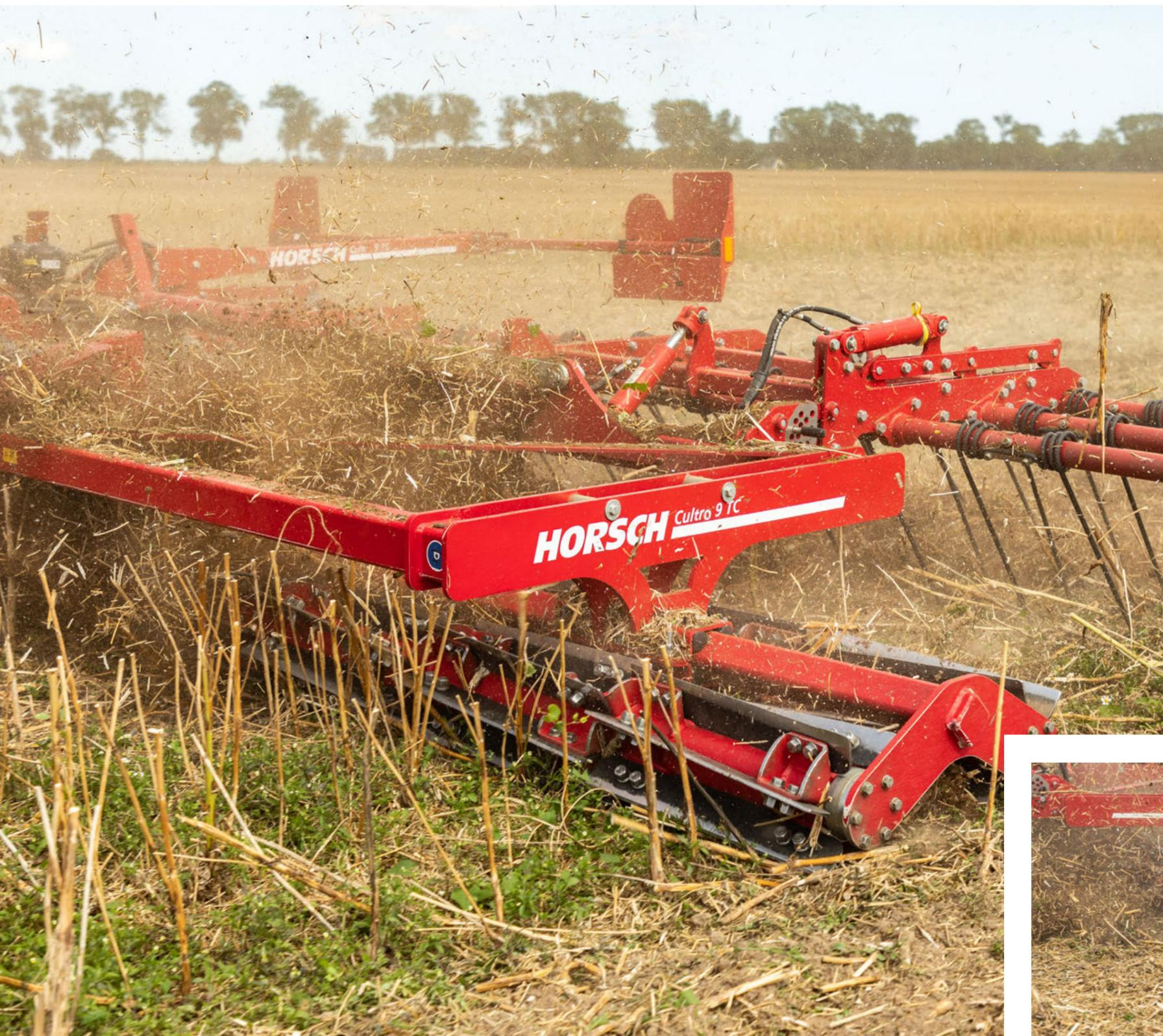
Die HORSCH Cultro TC ist eine Messerwalze, die durch ihre enorme Flächenleistung bei minimalem Kraftstoffaufwand überzeugt. Die hohe Flächenleistung wird durch eine Arbeitsgeschwindigkeit von bis zu 20 km/h erreicht. Je nach Konfiguration kann die Cultro im Front- oder Heckanbau gefahren werden. Ab 9 m Arbeitsbreite ist nur noch der Heckanbau möglich. Bei den Varianten Cultro 12 und 18 TC ist ein Fahrwerk integriert, um den komfortablen Straßen-transport sicherzustellen.
