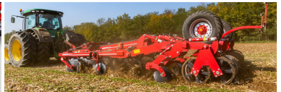
Intensive Bodenbearbeitung durch Scheiben und Zinken
