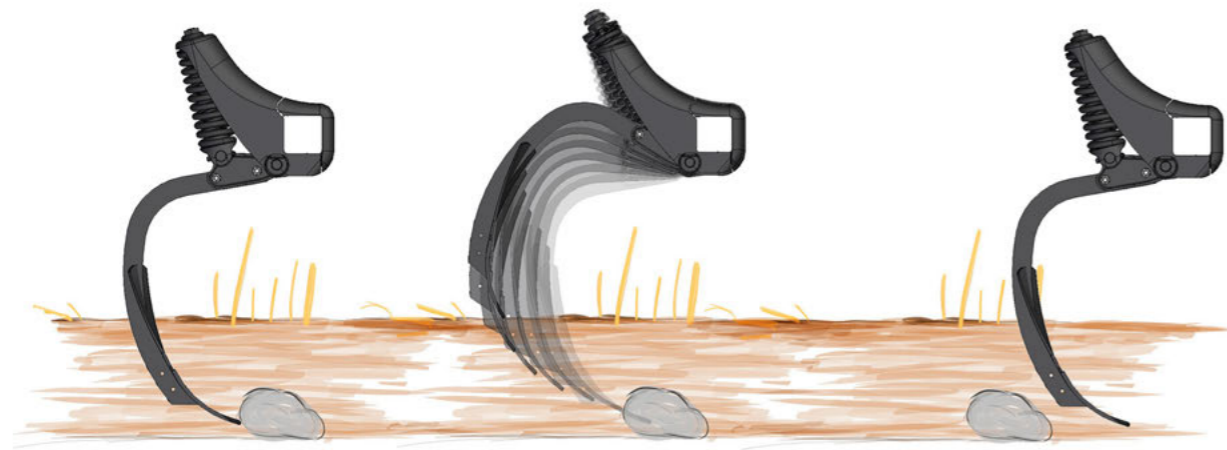
TerraGrip II – Auslösewirkung
