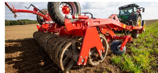
Doppel RollPack Packer mit Schwenkfahrwerk
