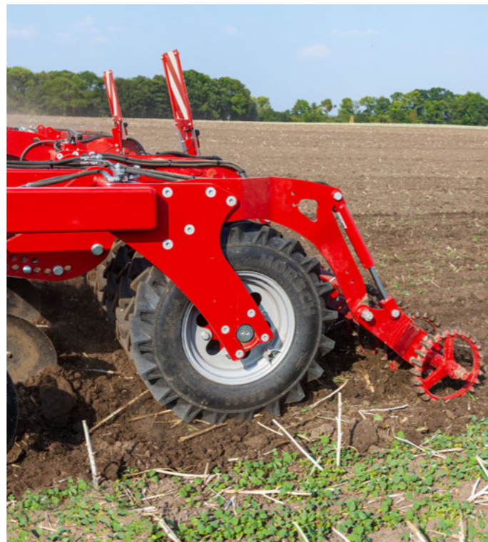
TopRing Packer für eine effektive Rückverfestigung zwischen den Reifen
