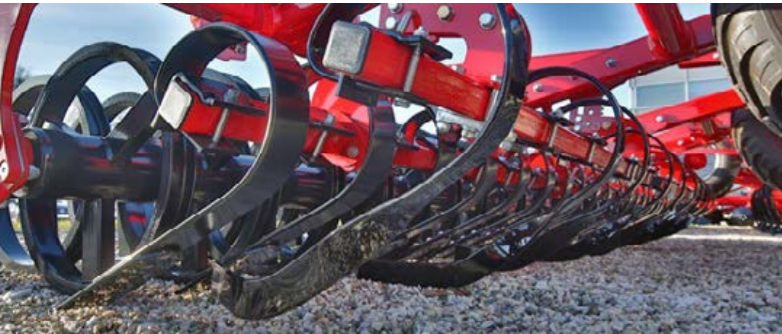
Crossbar Einebnung in Verbindung mit Nivellatoren
