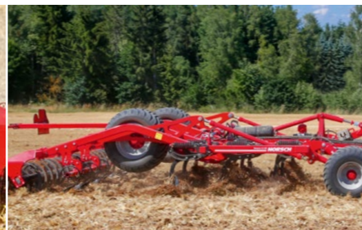
Aufgeräumte Bauweise mit Mittelfahrwerk in Arbeitsstellung
