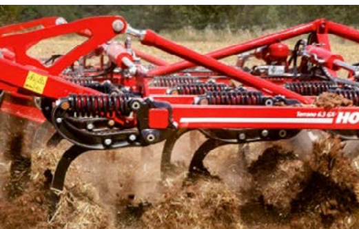
TerraGrip III mit 550 kg Auslösekraft
