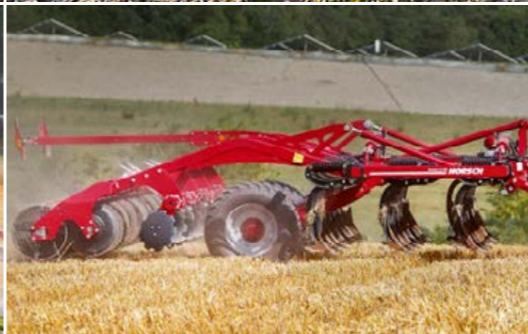
Wendig durch Mittelfahrwerk
