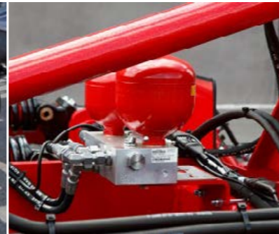
Serienmäßig verbauter Zugkraftverstärker
