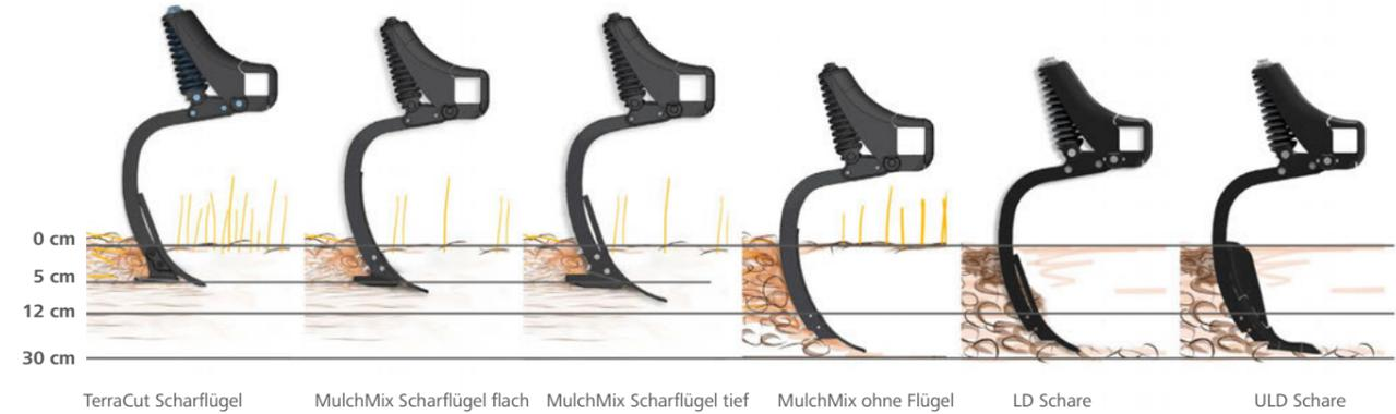
Durch die große Auswahl an Schar- und Flügelvarianten kann der Grubber für nahezu alle Bearbeitungstiefen vom flachen Schneiden auf 3 bis 4 cm bis hin zur Grundbodenbearbeitung eingesetzt werden. Dadurch kann das Einsatzspektrum enorm erweitert werden.
