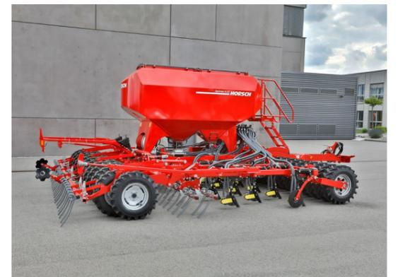
Der 2-reihige Striegel sorgt für eine optimale Kornbedeckung
