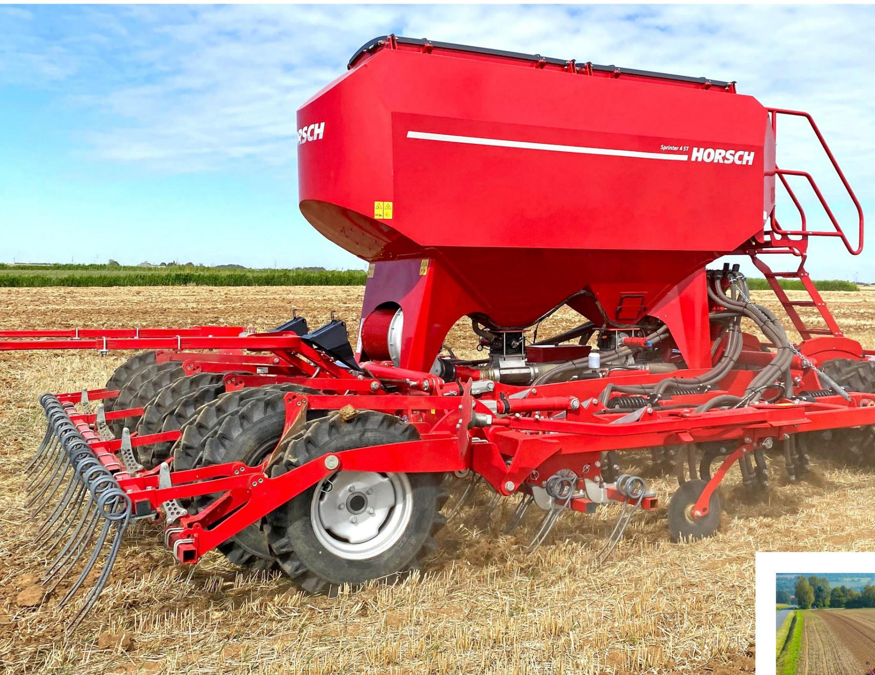
Eine Maschine, mit der Saatbettbereitung, Aussaat und Düngung in einem Arbeitsgang bewältigt werden können. Die robuste Zinkensämaschine HORSCH Sprinter hat ihre Stärken vor allem in der Mulchsaat. Die stabile Rahmenbauweise mit leichtzügigen Säscharen und großvolumigen Saatgutbehältern ermöglicht eine hohe Flächenleistung bei einem optimalen Kosten-Nutzen-Verhältnis.
