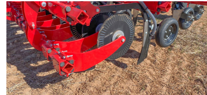
Sprinter NT einzelteiefengeführter Zinken
