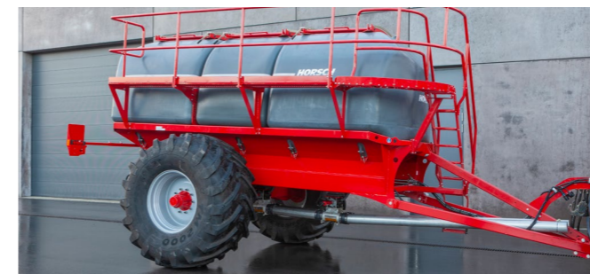
Großdimensionierte Bereifung reduziert Bodenverdichtungen
