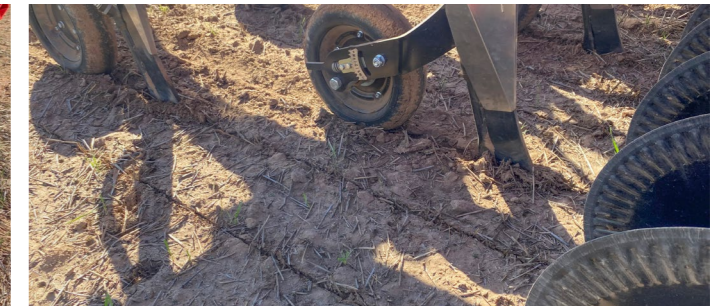
Minimale Erdbewegung dank Schneidscheibe und schmalen Zinken
