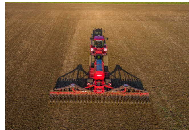
Sicheres Einhalten der eingestellten Ablagetiefe über die gesamte Arbeitsbreite durch hydraulische Gewichtsübertragung des Säwagengewichts auf die Scharflüge
