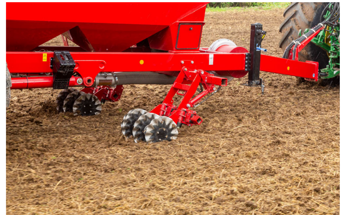
Lockerung von Bodenverdichtungen in der Traktorspur
