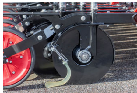
Fallrohrposition vor der Lagerung und beweglicher Innenabstreifer verhindern Verstopfungen der Schare unter feuchten Aussaatbedingungen
