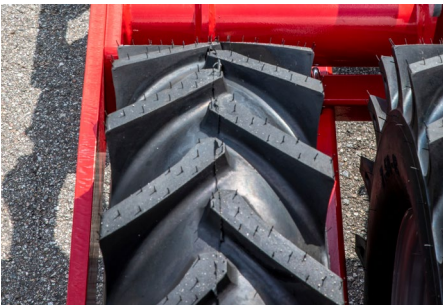
Gerades Reifenprofil erhöht die Rückverfestigung im Randbereich
