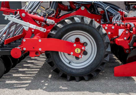
Hohe Leichtzügigkeit durch großen Reifendurchmesser und nicht benötigte Abstreifer
