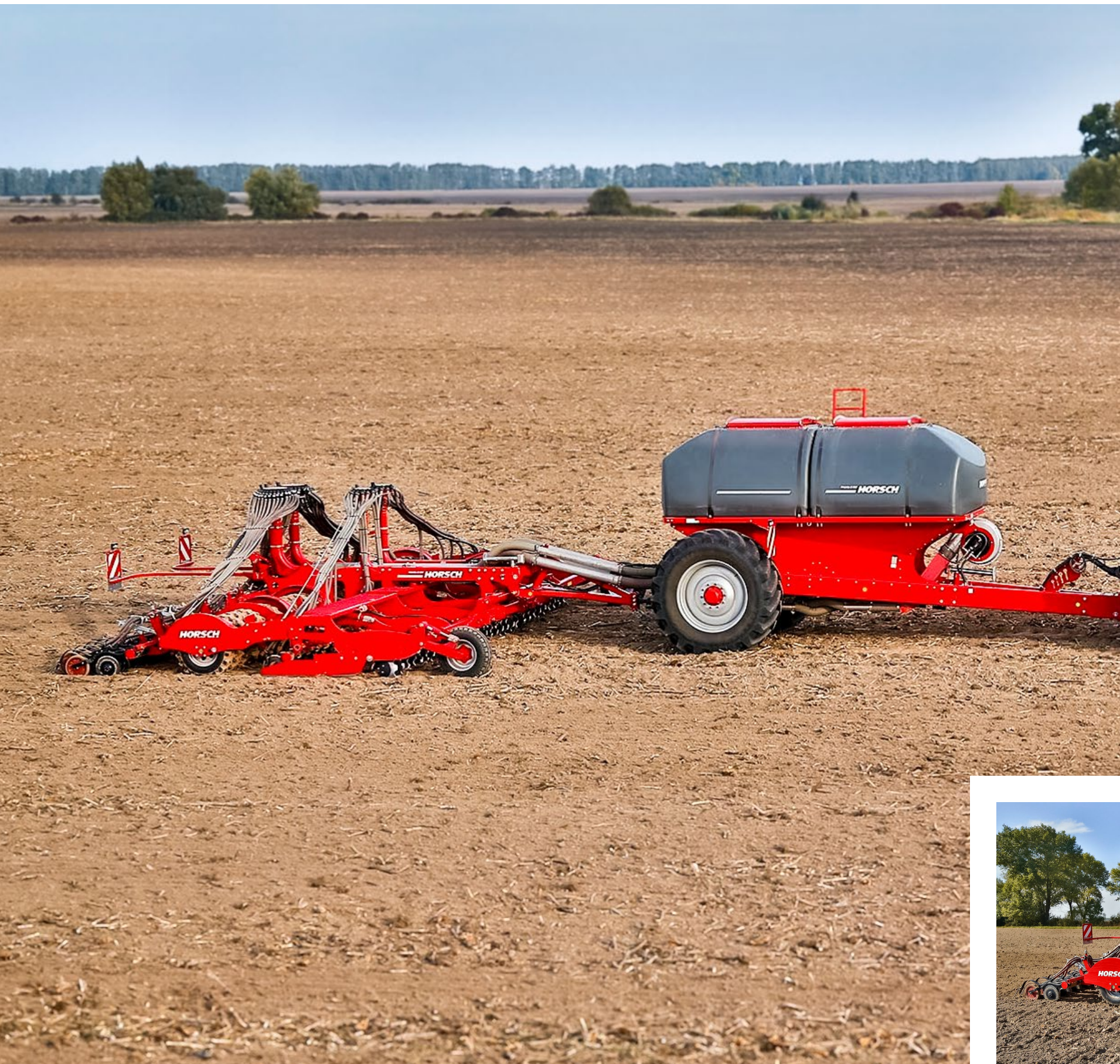
TurboDisc Säschar für präzise Saatgutablage und hohe Schardrücke
