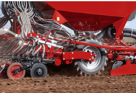
Effektive Rückverfestigung unter dem Saathorizont für optimale Wasserführung zum Saatkorn
