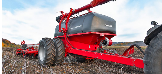
Doppeltank mit 6 000 l : 6 000 l Aufteilung oder Tripletank mit der Aufteilung 4 000 l : 2 000 l : 6 000 l
