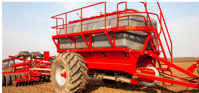
Doppeltank mit 8 500 l : 8 500 l Aufteilung oder Tripletank mit der Aufteilung 4 000 l : 6 500 l : 6 500 l
