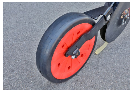
7 cm breite Andruckrolle – ideal auf leichten Böden
