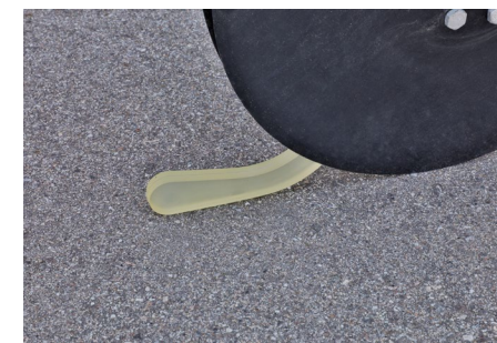
Der HORSCH Uniformer gewährleistet eine präzise Saatgutfixierung.
