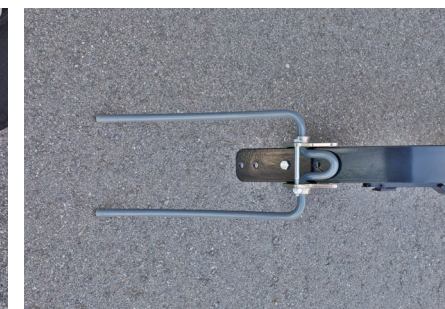
Der gerade Striegel – TurboDisc-Säschar wird für eine effizientere Bodenbearbeitung einzelscharengeführt
