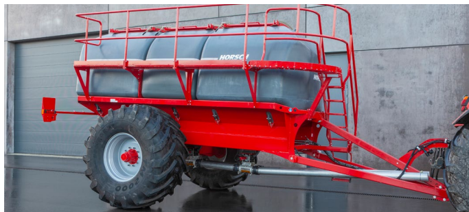
Großdimensionierte Bereifung reduziert Bodenverdichtungen
