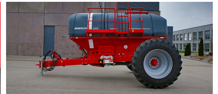
Möglichkeit für zwei weitere Komponenten wie Festdünger und Saatgut im zweiten und dritten Tank
