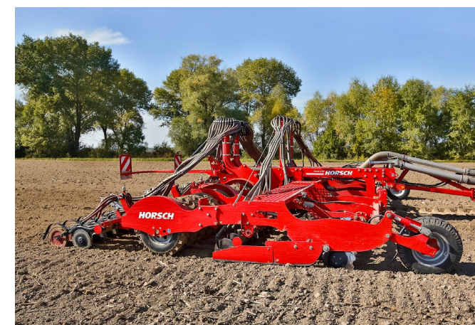
TurboDisc Säschar für präzise Saatgutablage und hohe Schardrücke
