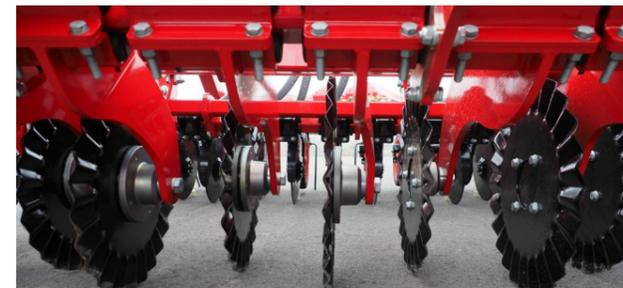
Lockerung der Oberfläche und Erzeugung von ausreichend Feinerde für eine optimale Saatguteinbettung
