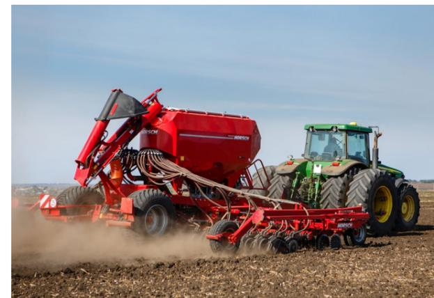
Hydraulische Befüllschnecke mit bis zu 800 kg/min Leistung
