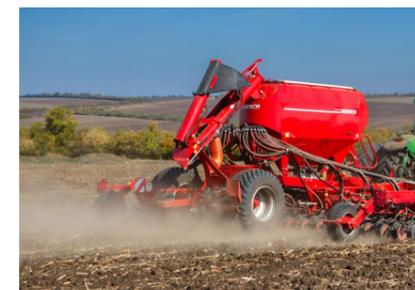
Einfaches Befüllen dank der hydraulischen Befüllschnecke
