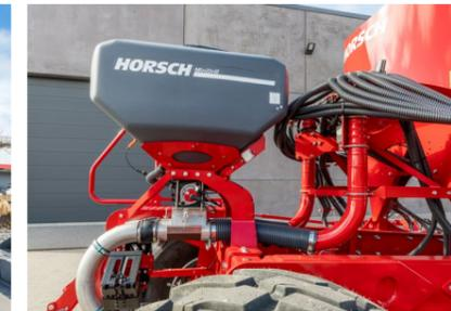
400 l Rapssaatgut in der MiniDrill ermöglichen es, die anderen Tanks mit mineralischem Dünger zu befüllen.
