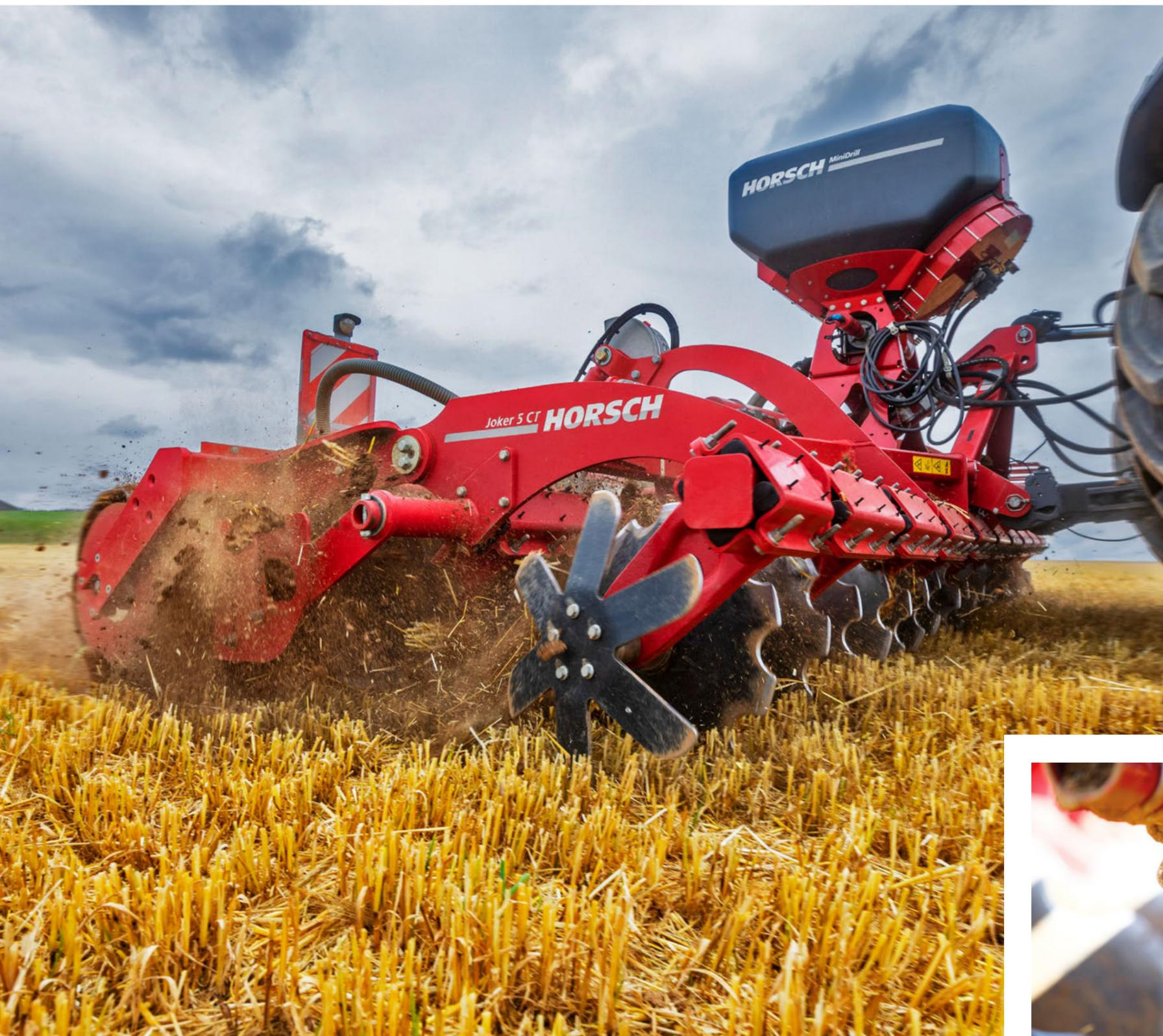
Die MiniDrill wurde entwickelt, um mit wenig Aufwand aus einem Bodenbearbeitungsgerät eine präzise Sämaschine zu machen. Speziell für Feinsämereien oder für die Ausbringung von Mikrogranulaten ist die MiniDrill sehr gut geeignet.
