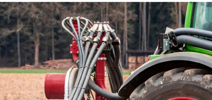
Verteilerturm für Dünger mit Düngeflussüberwachung sowie separater Turm für Mikrogranulat
