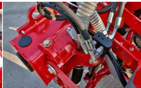
Geklemmte Anbindung der Reihen für einfache Umrüstung von 12 auf 8 Reihen sowie serienmäßig verbauter Hydraulikzylinder zur Schardruckerzeugung
