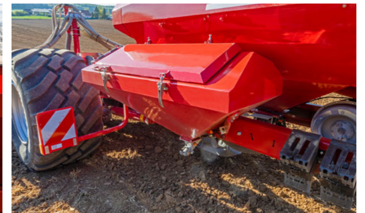
Zentrale Mikrogranulateinheit mit 300 l Volumen
