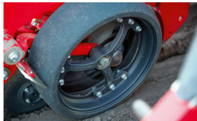
Speichertiefenführungsrad: bessere Selbstreinigung, daher ideal bei Schwarzerdeböden
