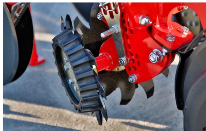
Optionale Räumsterne, schwimmend mit Tiefenführung
