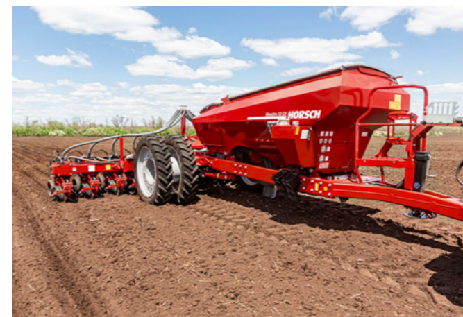
Düngertank 3 000 l und zentraler Saatguttank mit 800 l Kapazität
