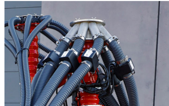
Pneumatischer Verteilerturm mit Düngerflusssensoren
