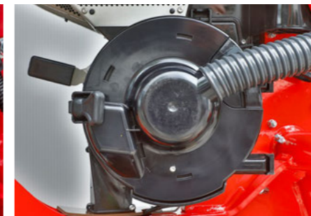
Gut zugänglicher AirVac Dosierer
