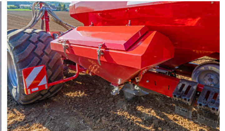
Zentrale Mikrogranulateinheit mit 300 l Volumen
