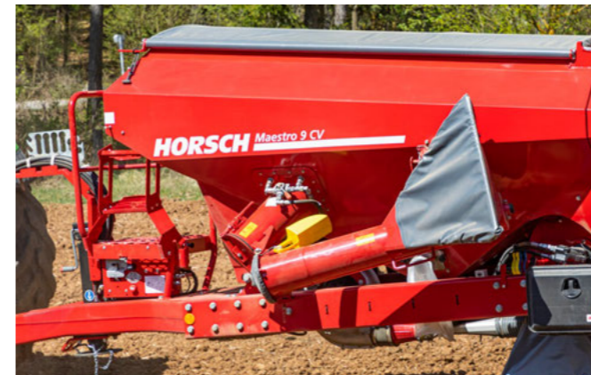
Befüllschnecke Einzeltank 400 kg/min
