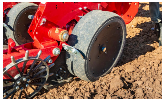
Standard Tiefenführungsrad für normale Bedingungen
