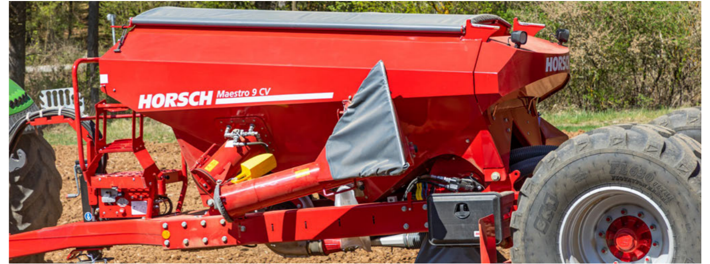
Eingeklappte, hydraulische Befüllschnecke Düngertank
