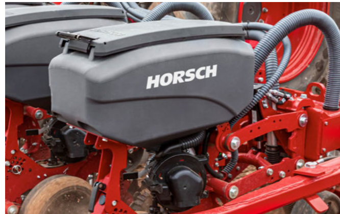
Reihenbehälter mit 70 l Volumen
