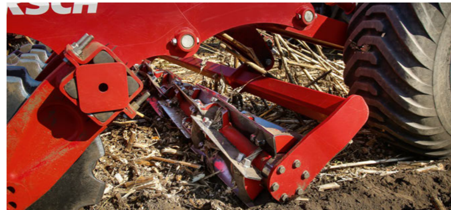
Messerwalze Hydraulisch vorgespannte Messerwalze für einen zusätzlichen Zerkleinerungseffekt.
