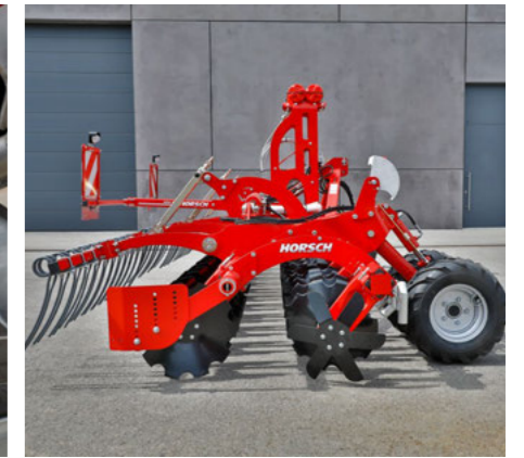
Gülleausführung ohne Packer, mit Striegel für geringste Verstopfungsanfälligkeit
