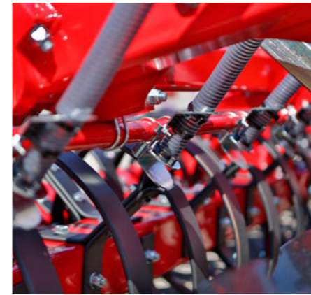
Säsiene für die Aussaat von Zwischenfrüchten in einem Arbeitsgang
