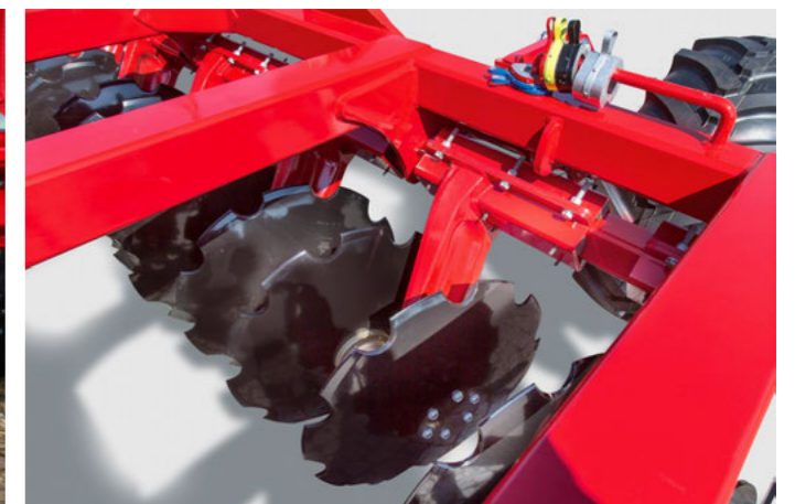
Großdimensionierte Scheiben mit einem Durchmesser von 62 cm
