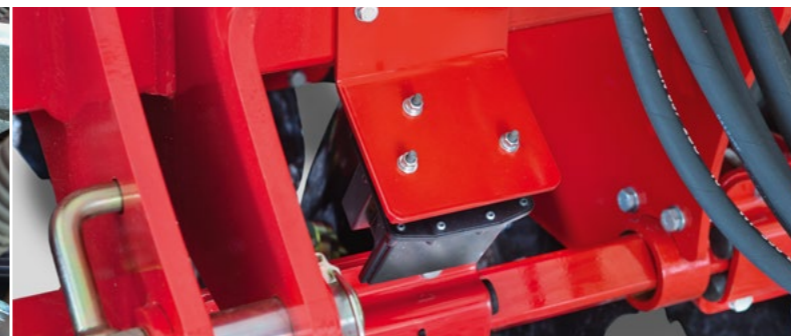
Radarsensor zur genauen Erfassung der Geschwindigkeit und Regelung der Saatmenge
