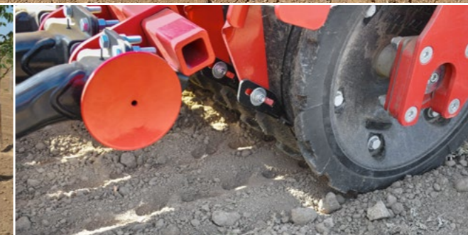
FarmFlex Packer mit 54 cm Durchmesser für streifenweise Rückverfestigung und universeller Eignung für alle Böden
