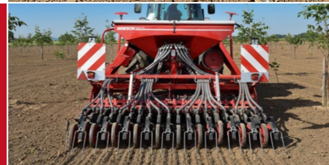
Sätank mit 1 500 Liter Inhalt
