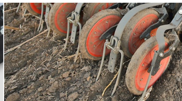
Doppelscheiben-Säschar Gerade Scheibe mit innenliegendem, wartungsfreiem Lager
