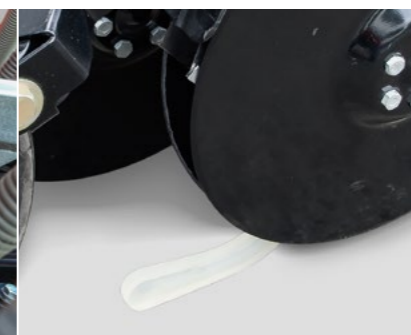
Uniformer und Abstreifer Sichere Saatgutablage in feuchten Bedingungen
