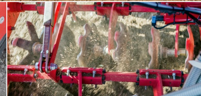
DiscSystem für intensive Bodenbearbeitung. Unempfindlich auch bei hohem Anteil an organischem Material.
