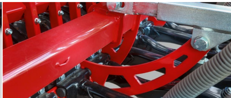
Stufenlose Scharldruckverstellung Manuelle Einstellung erhöht die Vorspannung der Gummielemente
