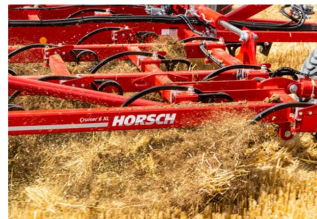
HORSCH Federzinken mit 150 kg Vorspannkraft
