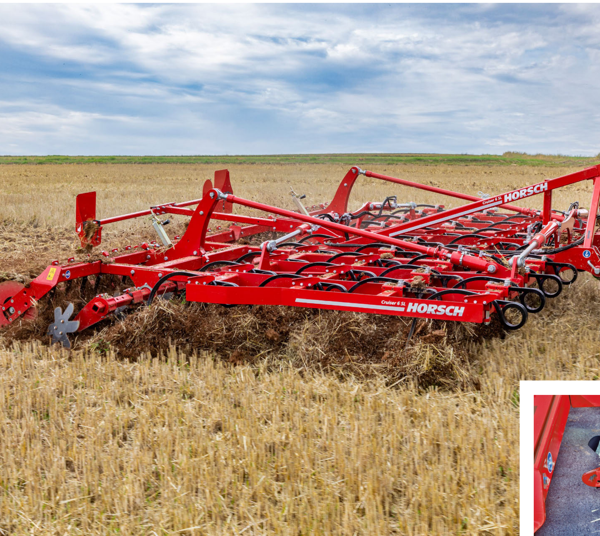
Gummigelagerte Einebnungsscheiben zum Schutz vor Überlast
