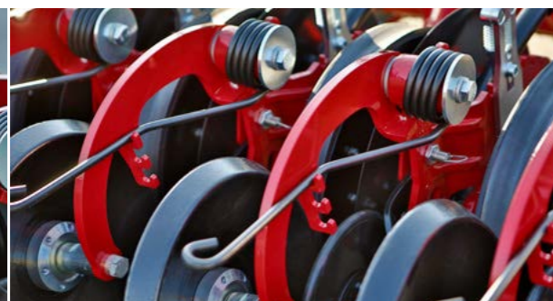
Der Anpressdruck der Schließrollen ist werkzeuglos über eine Feder einstellbar.
