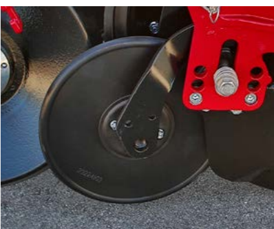
Druckrolle in der Saattrille für optimalen Bodenschluss des Saatgutes
