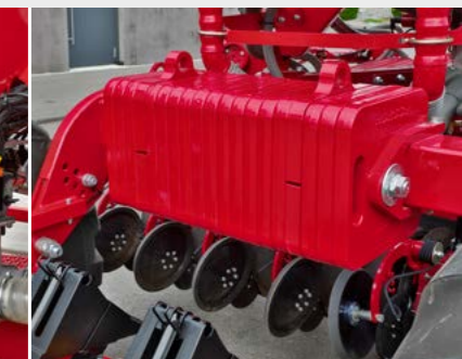
Optionale Zusatzgewichte, um einen höheren Schardruck realisieren zu können
