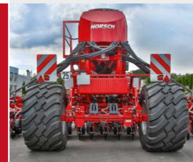
Optional: Bereifung 710/50–26.5 für maximale Aufstandsfläche
