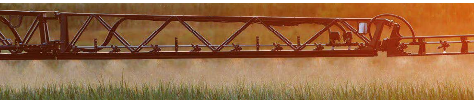
BoomControl – automatikus szórókeret vezérlés az ultrahangos szenzorok által
