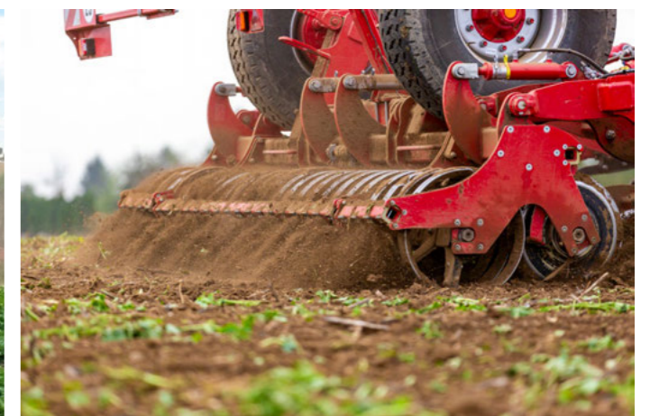
Production importante de terre fine grâce au rouleau SteelFlex
