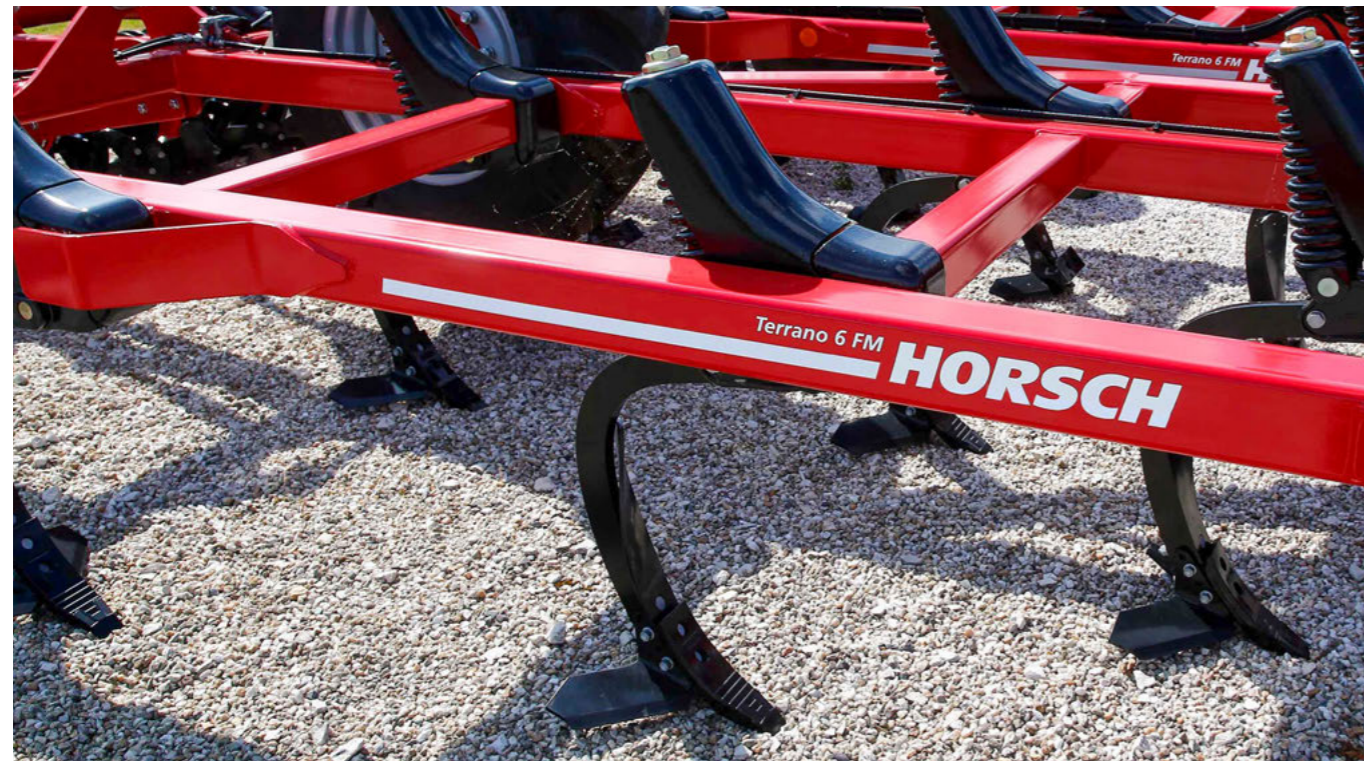
Dent TerraGrip avec sécurité non-stop
