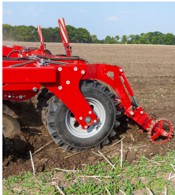
Rouleau TopRing pour un rappui efficace entre les roues
