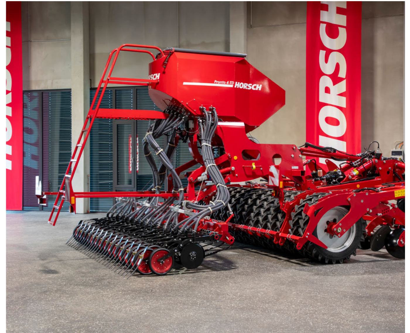
Pronto TD pour allier travail du sol et semis en un seul passage
