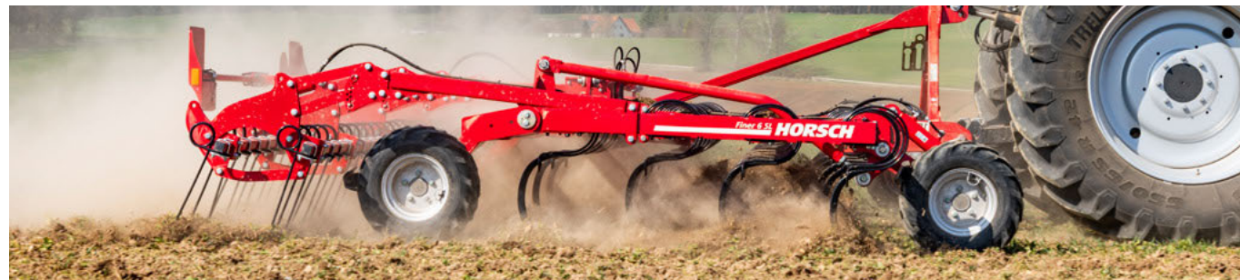
Opzionale con ruote di controllo della profondità posteriori invece del rullo
