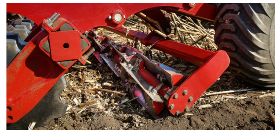
Opcionális hidraulikusan előfeszített késhengerrel a további aprítási hatás érdekében.
