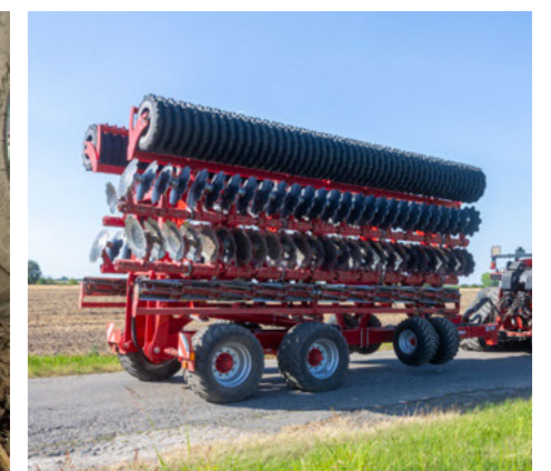
Tandem futómű a nyugodt közúti szállításért
