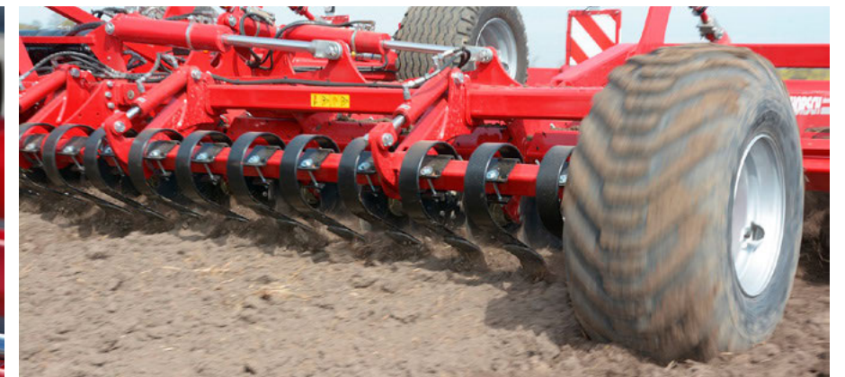
Opcionálisan Crossbarral a kiegészítő egyengetőhatás érdekében
