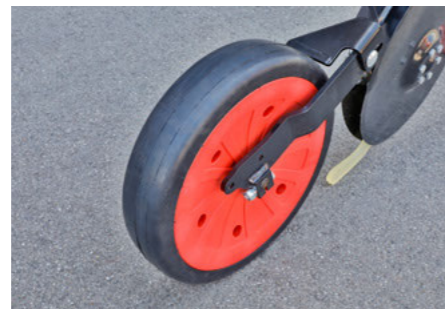
7,5 cm széles nyomógörgő – ideális könnyű talajokon
