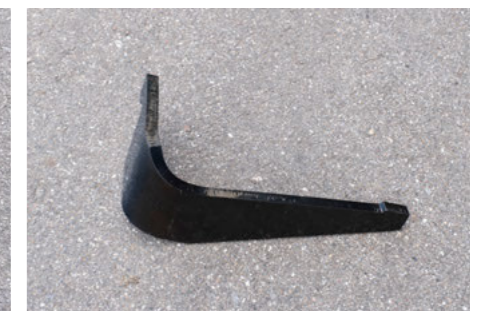
Fogak húzásra: intenzív bekeverés és kemény talajok fellazítása, valamint szerves anyagok kiváló bekeverése
