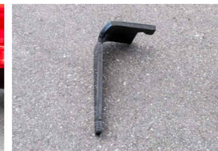
A fogak húzásra szerelve a forgóboronából forgókultivátort csinálnak.
