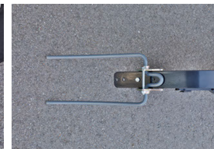
Az egyenes gereblye – TurboDisc-csoroszlyán a hatékonyabb talajművelés érdekében soronként kerül felszerelésre.
