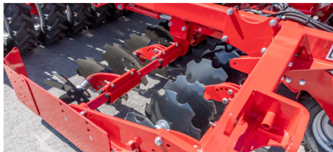
DiscSystem állítható nyomlazító tárcsákkal
