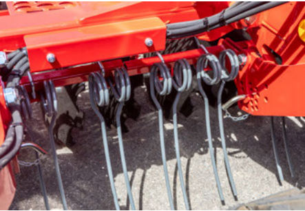
A gereblye a DiscSystem és a gumikerekes henger között van elhelyezve. A beállítás mechanikusan történik egy furatképen keresztül.
