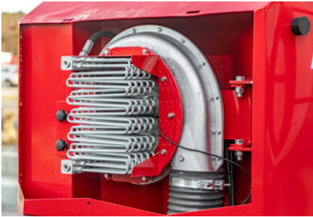
Csökkenti az olaj hőmérsékletét a rendszerben, és tehermentesíti a traktor olajhűtőjét
