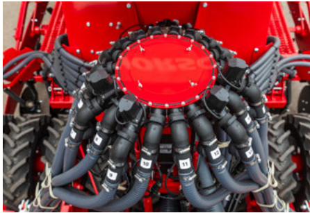
A légáramlás ellenőrzése az elosztótornyánál
