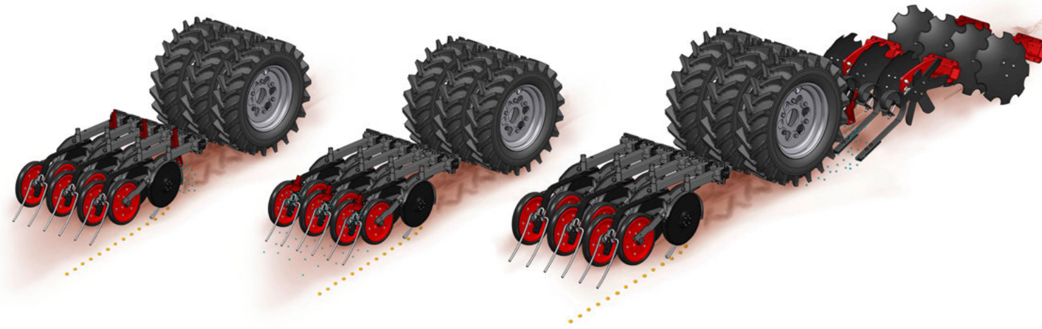
MiniDrill változat 9: Kijuttatás ütközőlapon keresztül az opcionális Crossbaron. Ideális az alávetések kijuttatására, mivel ezeket a gumikerekes henger ismételtlen lenyomja.
