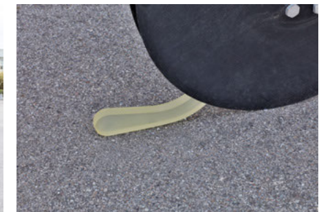
A HORSCH formázó biztosítja a vetőmag pontos rögzítését.
