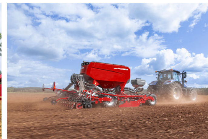
A PPF duplatartály rendszer lehetővé teszi 2 komponens külön adagolását és elhelyezését 2 horizonton.
