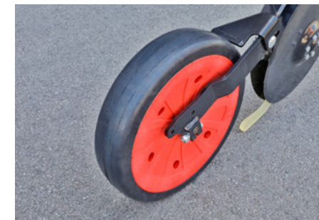
ParaDisc vetőcsoroszlya – 7 cm széles nyomógörgő
