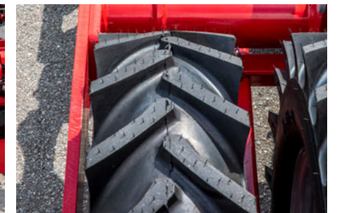
Egyenes abroncsprofil növeli a visszatömörítést, a gumik szélső felületén is.
