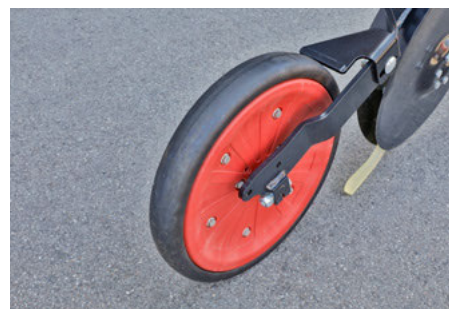
5 cm széles nyomógörgő – ideális közepes és nehéz talajokon
