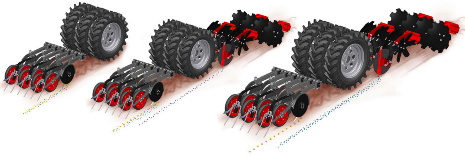
MiniDrill Változat 1 & 2 – Kijuttatás a vetőcsoroszlyába
