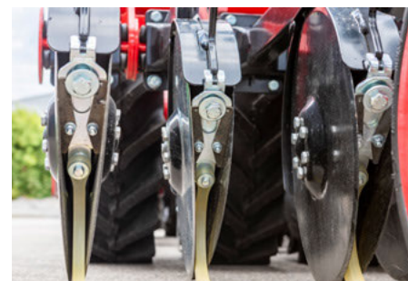
A mozgó sárkaparó garantálja a magas fokú öntisztulást nedves körülmények között.
