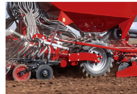
Hatékony visszatömörítés a vetési horizont alatt, a vetőmag optimális vízhez való hozzáférése érdekében.
