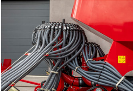
Kúlsó PPF elosztótorny az optimális hozzáférhetőség érdekében
