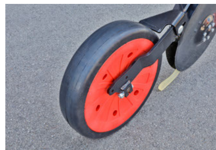
7,5 cm széles nyomógörgő – ideális könnyű talajokon
