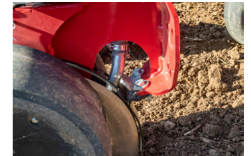
Pneumatická aplikace DO setového lůžka
