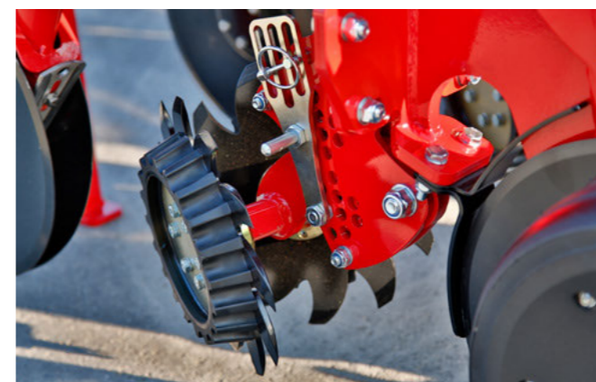
Volitelné hvězdicové odhrnovače rostlinných zbytků – plovoucí s hlubkovým vedením
