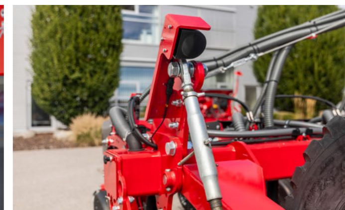
Jeden z dalších radarových senzorů pro ContourFarming
