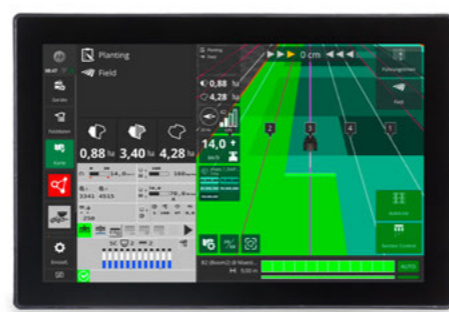
S pomocí technologie přesného setí a HORSCH AutoLine lze kolejové řádky zakládat zcela flexibilně a nezávisle na směru jízdy s podporou GPS.
