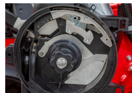
Univerzální jednotící stěrka, kterou není třeba nastavovat
