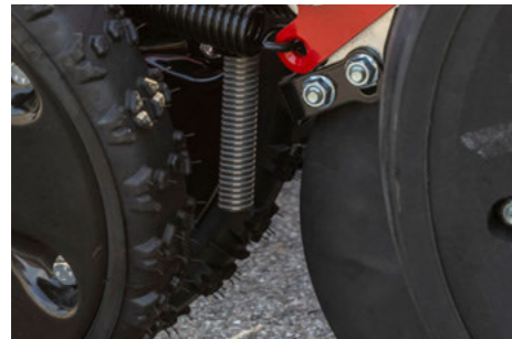
Aplikace kapalného hnojiva za přitlačné kolečko
