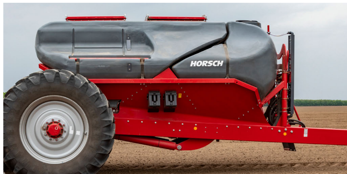
System kapalného hnojiva sestávající se z nádrže, čerpadla, monitorování řádků a sekčního ovládání
