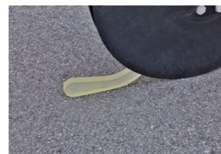
HORSCH Uniformer zajišťuje přesné uložení osiva
