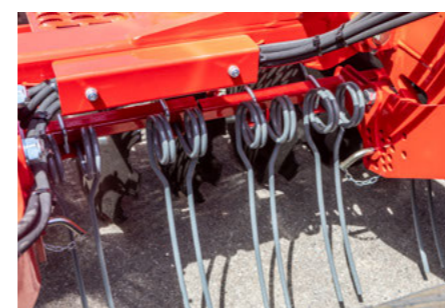
Prutové brány jsou umístěny mezi DiscSystémem a pneumatikovým pěchem Nastavení se provádí mechanicky pomocí otvorů.
