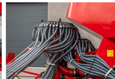
PPF rozdělovač umístěný mimo stroj pro optimální přístup
