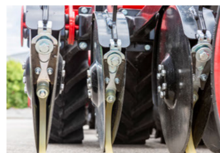
Pohyblivá stěrka zajišťuje vysokou sebečisticí schopnost za vlhkých podmínek
