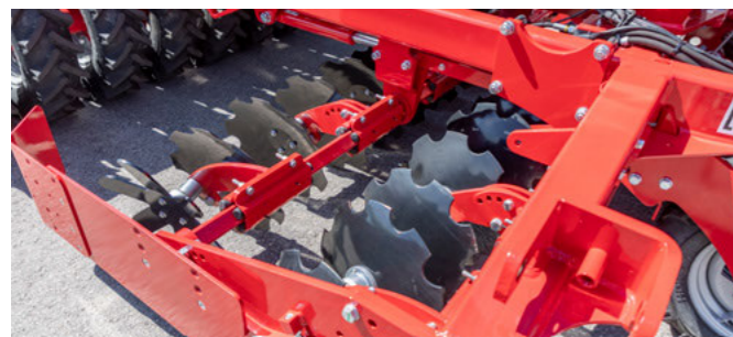
DiscSystem s nastavitelnými rameny disků za koly traktoru pro kypření stop
