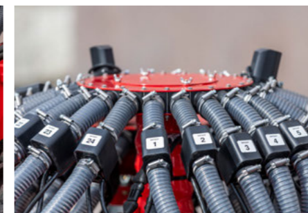
Pneumatický systém pro sečí špaldy a podobného osiva
