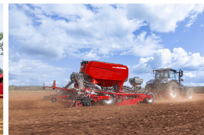
Systém dvoukomorového zásobníku PPF umožňuje oddělené dávkování a ukládání dvou složek do dvou různých hloubek
