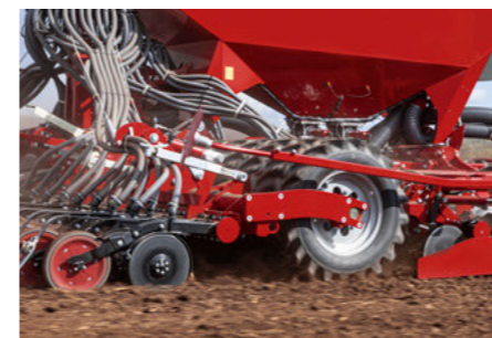
Účinné utužení pod seťovým lůžkem pro optimální vztlínání vody k osivu
