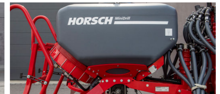
Autonomní varianty MiniDrill s vlastním dmychadlem, vlastním pneumatickým systémem a možností ukládání do další hloubky
