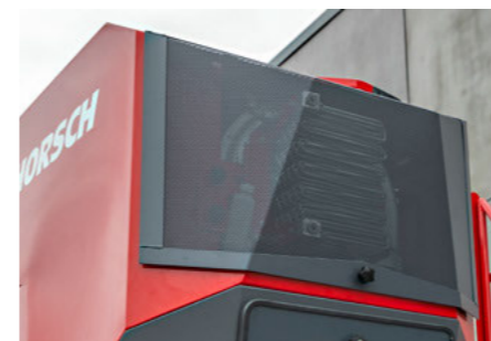
olejový chladič na ventilátoru – ohřívá proud vzduchu v pneumatickém systému
