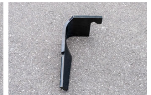
HM+ hřeby mají 130 mm dlouhý tvrdokovový potah. Mají dlouhou životnost na těžkých kamenitých půdách.
