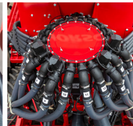
Kontrola průtoku vzduchu hlavami
