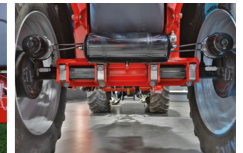
Oś wtykowa służy do mechanicznej regulacji rozstawu śladu w zależności od opon – od 1,50 m do 2,25 m
