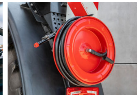
Wąż nawijany na bęben do mycia opryskiwacza z zewnątrz
