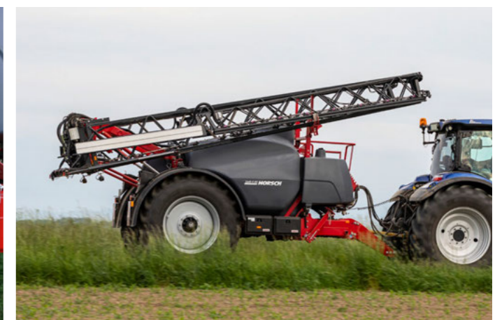
5-segmentowa belka z kompaktowym składaniem/rozkładaniem
