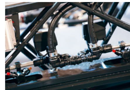
HORSCH Leeb 4 AX – elektryczne przełączanie dysz
