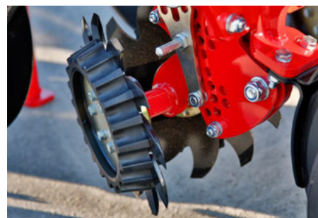
Opcionális rögtelők, úszó beállítás mélységtartással
