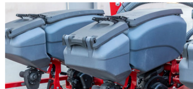
Mikrogranulátum tartály 18 l térfogattal
