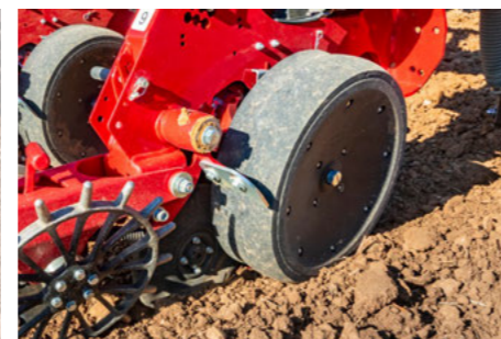
Standard mélységtartó kerék normál körülményekhez
