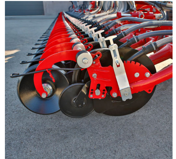
Tökéletes vetőmag rögzítés, a gumírozott fogókeréknek köszönhetően
