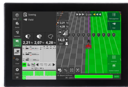
Univerzális vetéstechnikával és HORSCH AutoLine-nal lehet függetlenül a művelőút-ritmustól vetni
