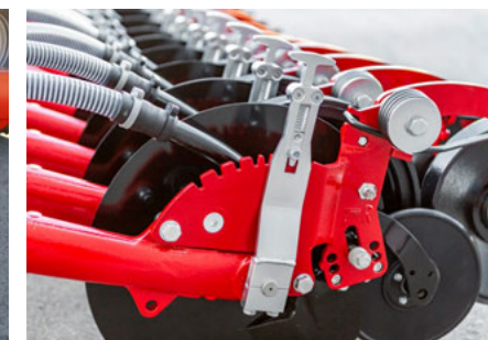
Szerszám nélküli egyedi mélységállítás kis fokozatokkal
