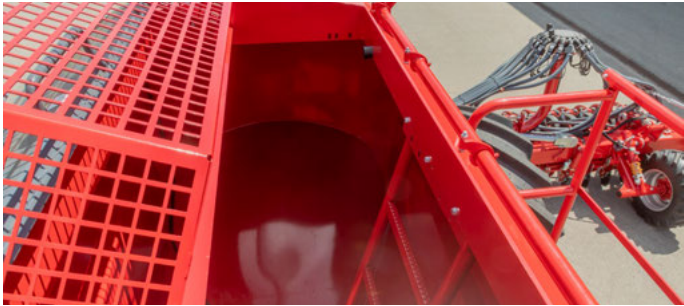
Kihajtható rács, így nem kerülnek szennyeződések a tartályba.
