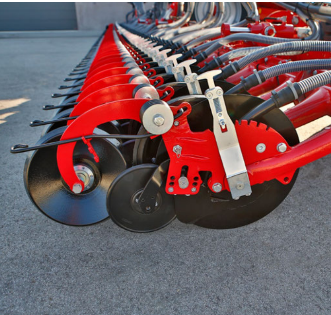
Tökéletes vetőmag rögzítés, a gumírozott fogókeréknek köszönhetően
