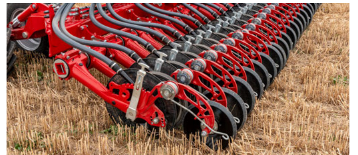
Egyedi mélységtartású egytárcsás vetőcsoroszlya NarrowDisc
