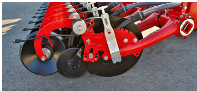
SingleDisc tökéletes talajkövetés a mélységvezető kereknek köszönhetően
