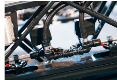
HORSCH Leeb 4 AX – електричне керування форсунками
