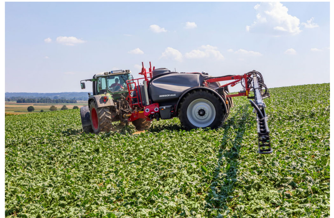
Поворотне дишло: захист рослин і точне копіювання колії трактора
