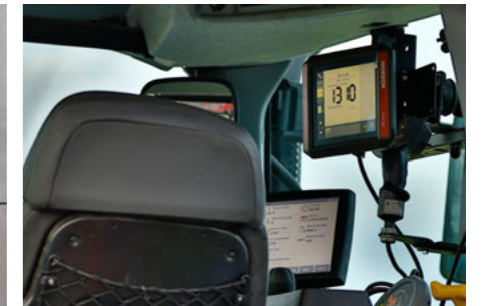
Електронна наглядна шкала рівня заповнення на терміналі
