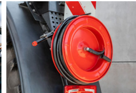
Шлангова котушка для зовнішнього очищення
