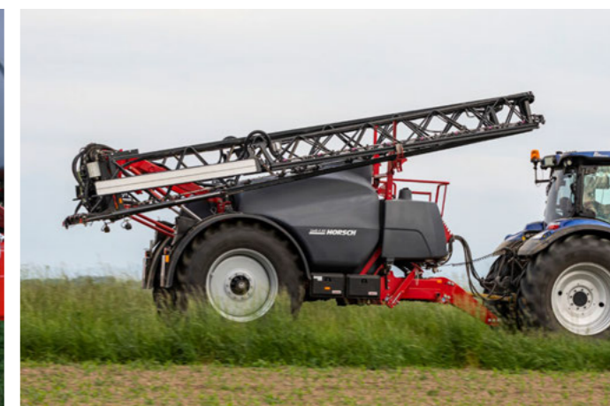
5-секційна штанга з компактним складанням
