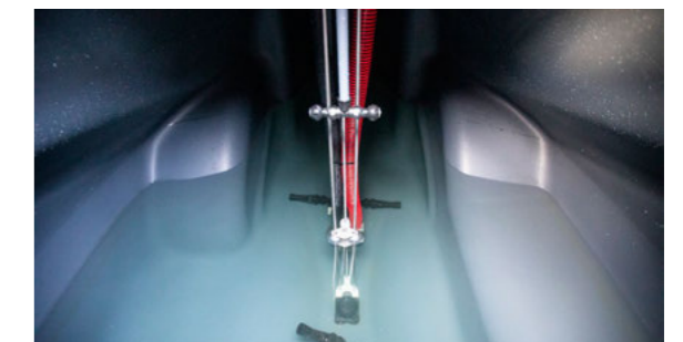
Внутрішній вигляд резервуара Leeb 4 AX: потужний змішувач та форсунки для промивання
