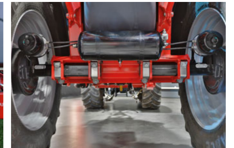
Розсувна вісь для механічного регулювання ширини колії від 1,50 до 2,25 м залежно від шин
