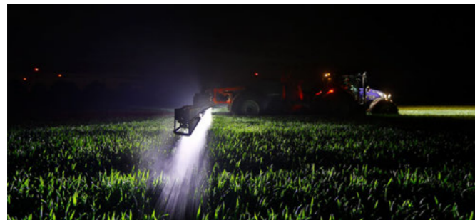
NightLight — освітлення конуса обприскування
