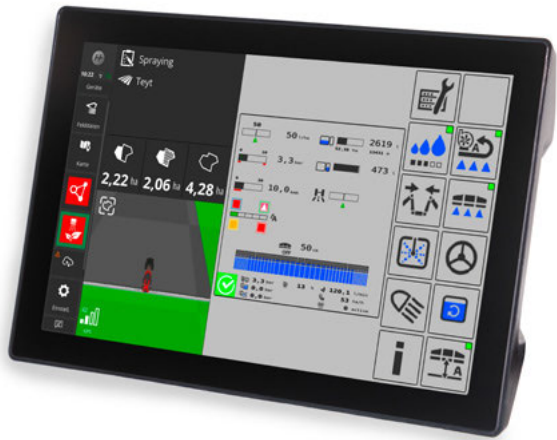
Отображение до трех виджетов рядом с основным рабочим экраном позволяет одновременно следить за работой нескольких приложений
