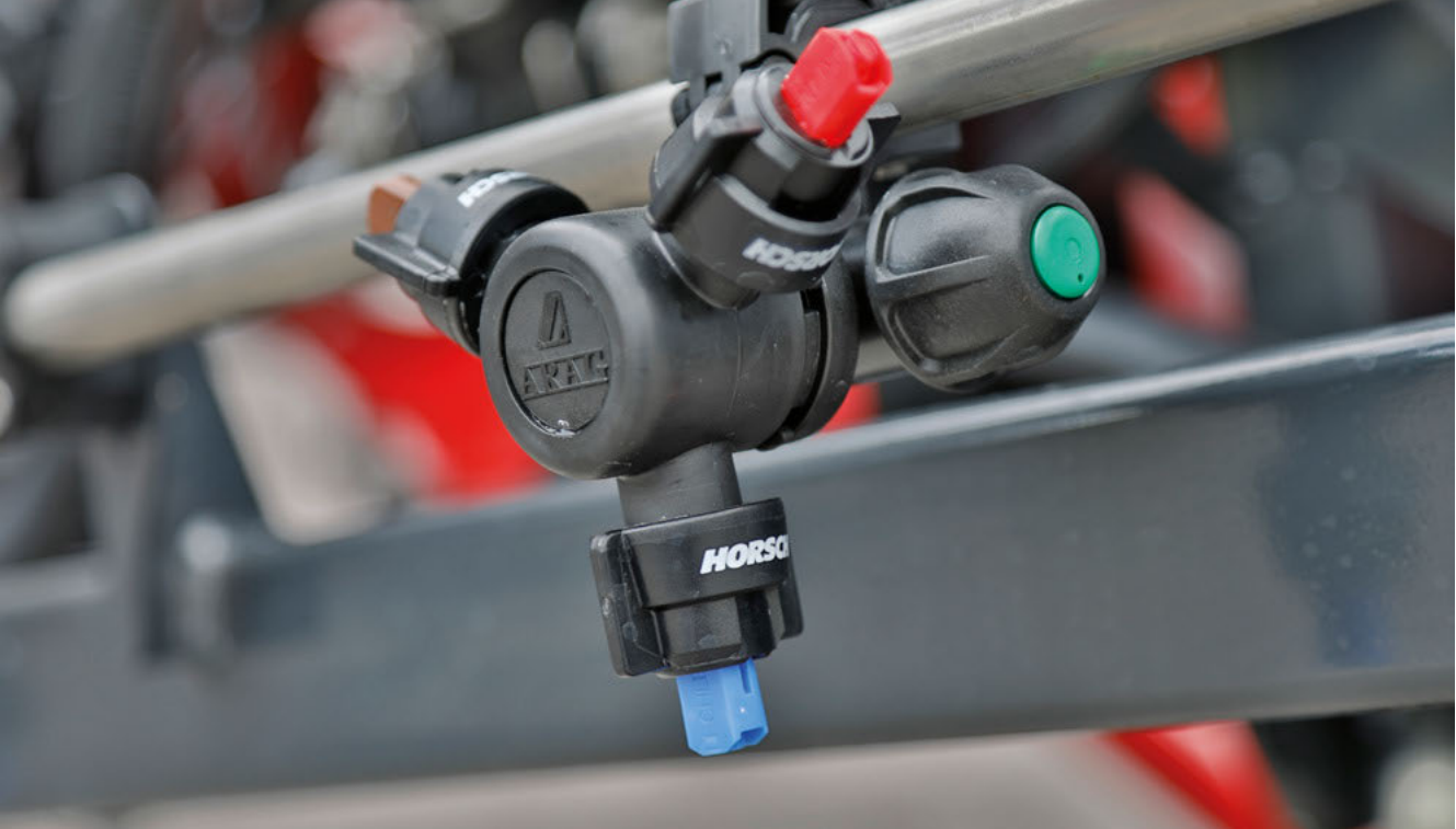
HORSCH Leeb 4 AX: переключение форсунок 1-0 (3-поз. корпус с ручным переключением)
