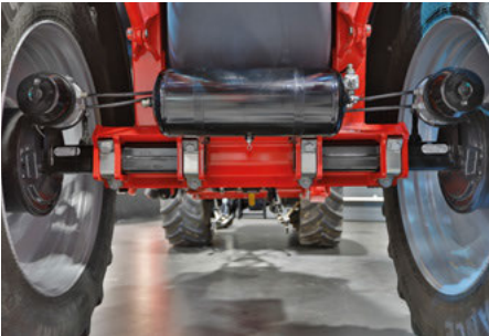
Раздвижная ось для механической регулировки колеи в диапазоне от 1,50 до 2,25 м в зависимости от размера шин
