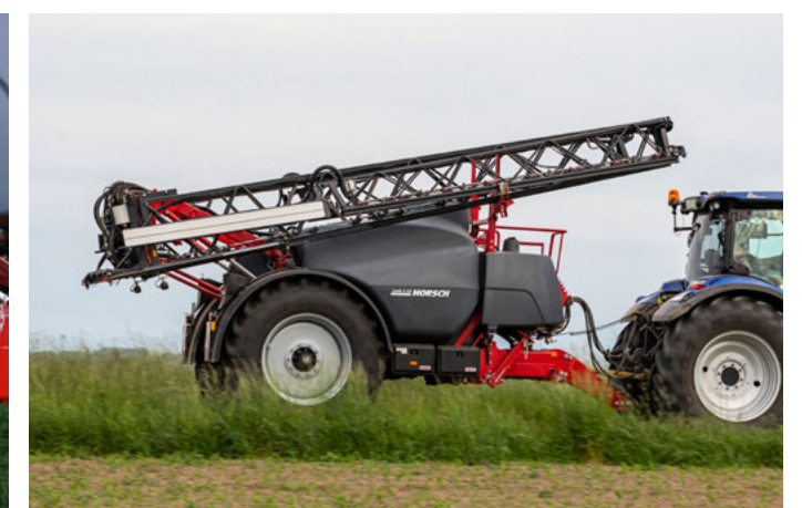
5-секционная штанга с компактным складыванием
