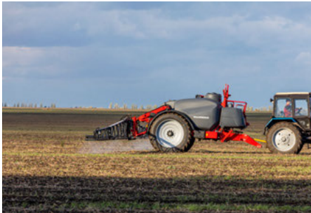
Минимальные требования к трактору благодаря автономной гидравлической системе
