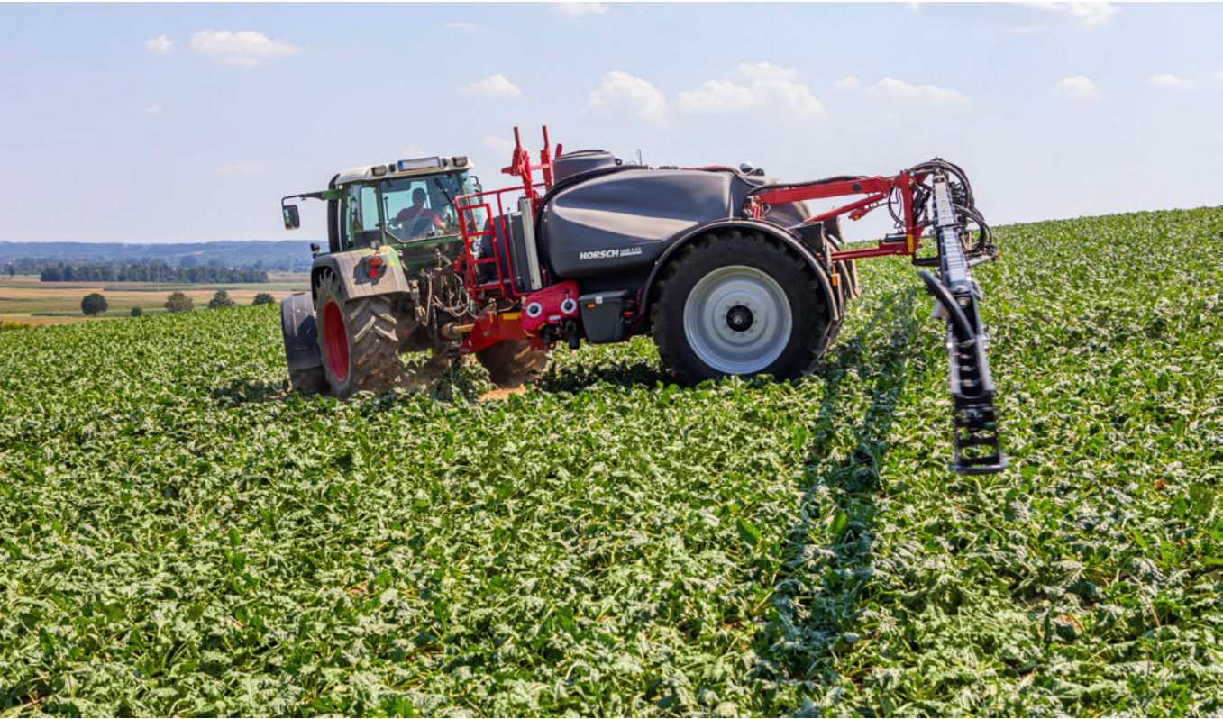
Поворотное дышло: точное следование по колеи и максимальное сохранение посевов
