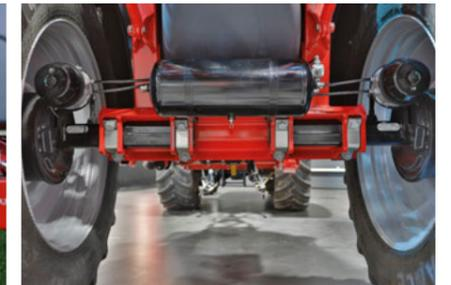
Essieu réglable pour le réglage mécanique de la largeur de voie de 1,50 jusqu'à 2,25 m
