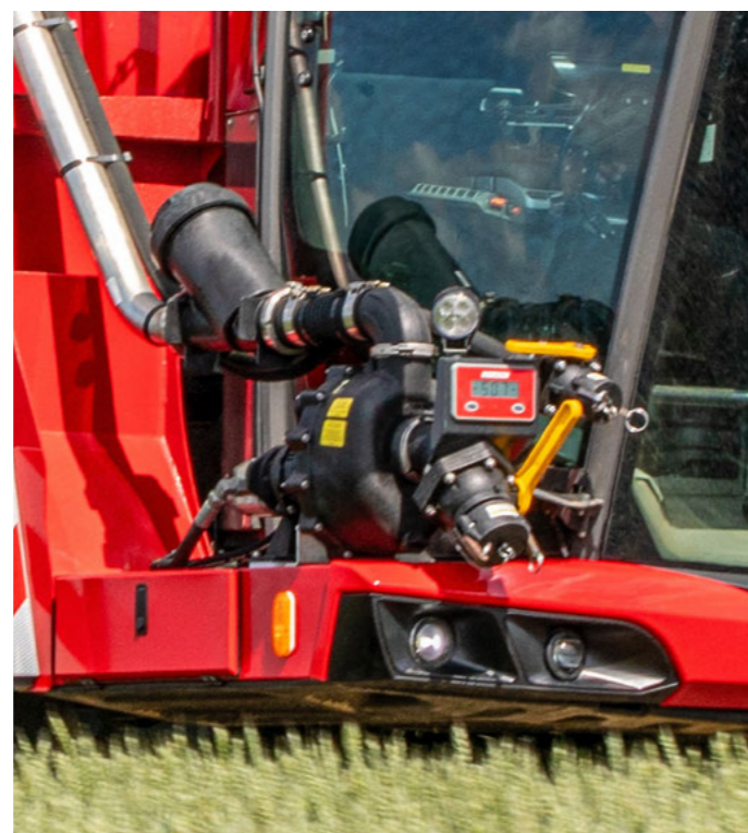
PowerFill plnicí čerpadlo s výkonem 1 000 l/min - 3" Camlock plnicí přípojka vpředu a displej
