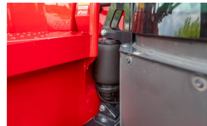
Pneumatické 4-bodové odpružení kabiny
