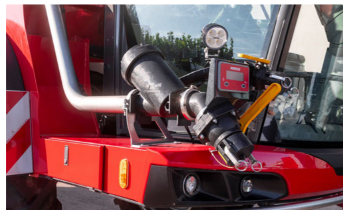
52 l nerezová přímichávací nádoba včetně přídatné míchací trysky
