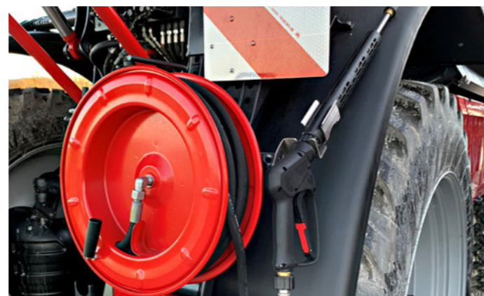
Hydraulicky poháněný vysokotlaký čistič
