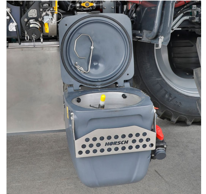
52 l nerezová přimíchávací nádoba včetně přidavné míchací trysky
