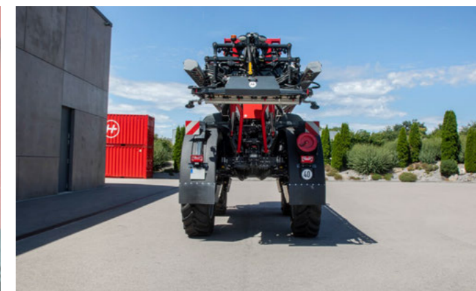
Za sebou umístěné posuvné nápravy a hydropneumatické odpružení
