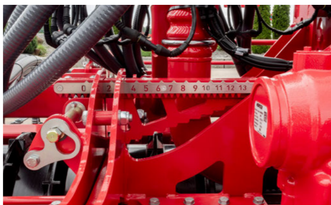
Indicateur de la profondeur de travail de la herse rotative en acier inoxydable – Réglage mécanique par clé universelle
