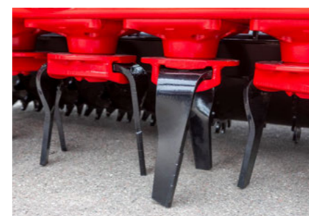
Dents Endurance avec pastilles carbure de 130 mm dans la zone travaillante pour une longévité accrue, notamment en conditions difficiles et pierreuses
