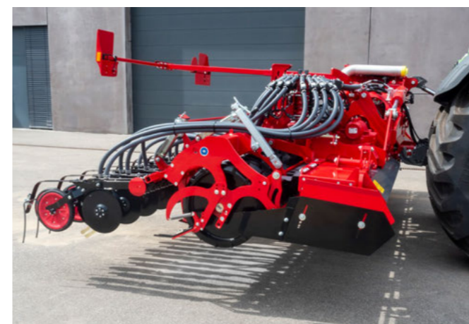
Combiné de semis compact et maniable en version portée
