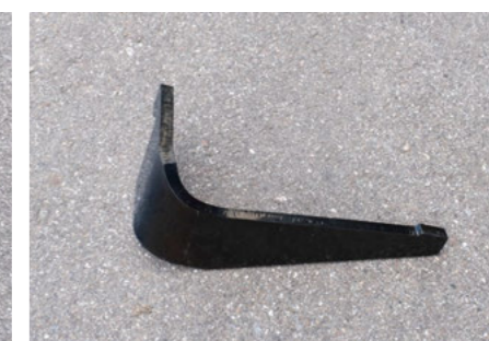
Dents attaquantes : elles permettent un mélange et ameublissement intensifs des sols durs et une excellente incorporation des matières organiques
