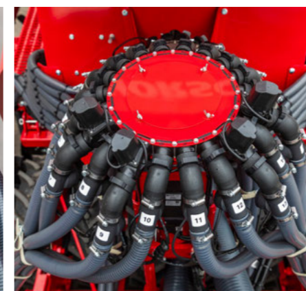
Contrôle du flux pneumatique sur la tête de répartition
