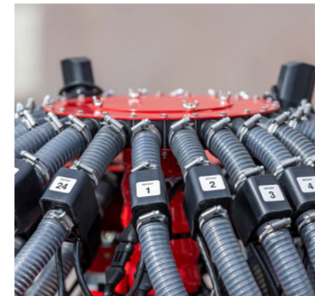
Dinkel-Pneumatik für spelzhaltige Saatgüter
