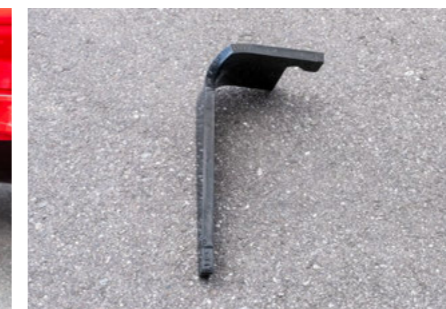
Zinken auf Griff machen aus der Kreiselegge einen Kreiselgrubber
