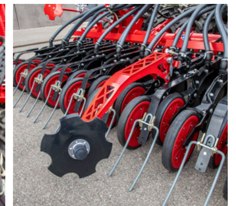
Die Aggressivität des Voraufmarkierers wird über einen Tiefenanschlag eingestellt
