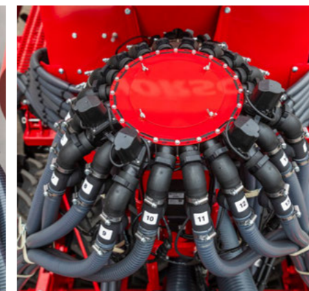
Überwachung des Pneumatikdurchflusses am Verteilerturm
