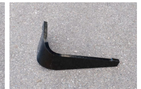
Zinken auf Griff: intensives Durchmischen und Auflockern von harten Böden sowie hervorragendes Einmischen von organischem Material
