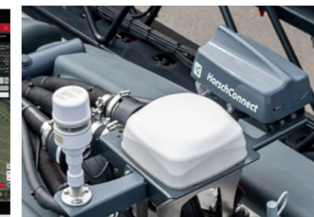
Collegamento digitale con HorschConnect, GPS e una stazione meteorologica per un adattamento ottimale alle condizioni ambientali attuali.
