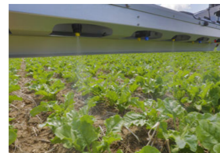
Anche la spruzzatura a banda non è un problema per una spazatura di 25 cm
