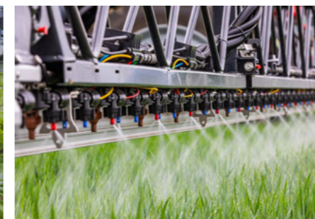
Distanza tra gli ugelli di 25 cm: più ugelli, più possibilità, ad esempio applicazione 3D
