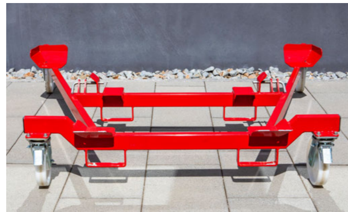
Il robusto carrello di manovra semplifica la gestione de la macchina
