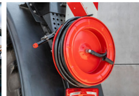
Avvolgitubo per la pulizia esterna
