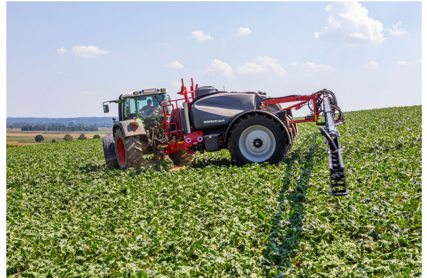
Sterzata del timone: protezione delle colture e tracciamento preciso nella traccia del trattore
