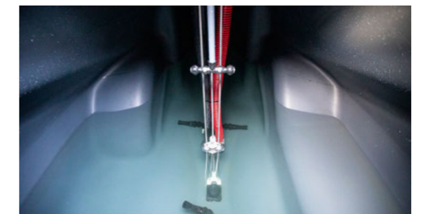
Vista interna del serbatoio Leeb 4 AX: potenti ugelli di agitazione e pulizia
