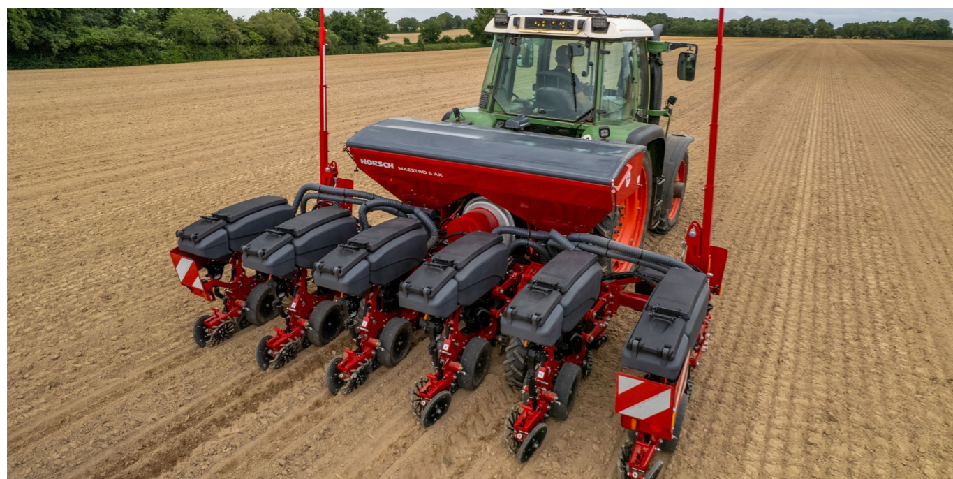
Trémie à engrais de 1 100 l avec coupeure demi-semoir
