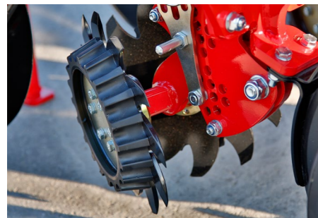
Étoile chasse résidus en option, en position flottante avec contrôle de terrage
