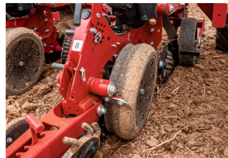
La roue RID minimise le rappui en bordure de sillon en conditions très dures ou en semis direct
