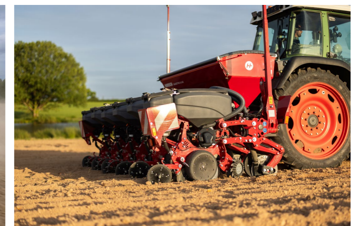
Cuve de microgranulés sur le rang en option
