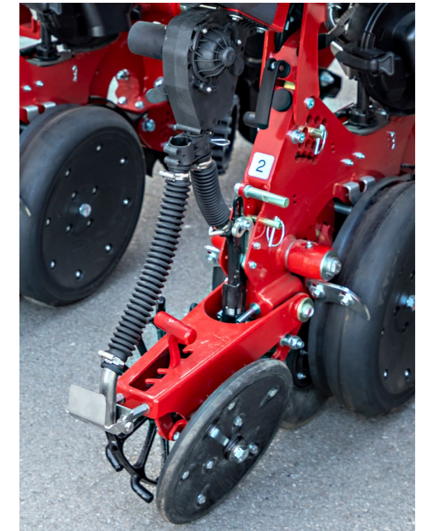
Microgranulateur sur le rang avec deux zones d'application au choix
