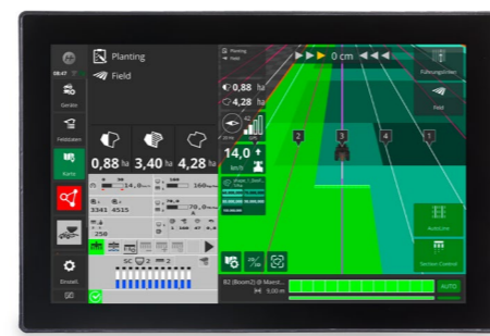
Sur les semoirs monograine et la fonction HORSCH AutoLine, les passages de pulvérisation (Tramelines) peuvent être semés de manière totalement flexible et indépendante du sens de conduite et du rythme de jalonnage grâce à la position GPS.
