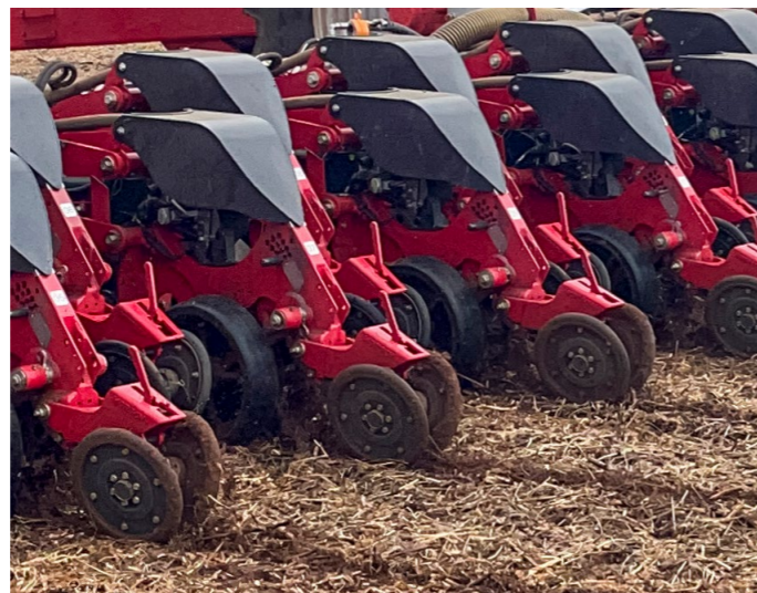
Alteração de 45 para 90 hidráulicamente
