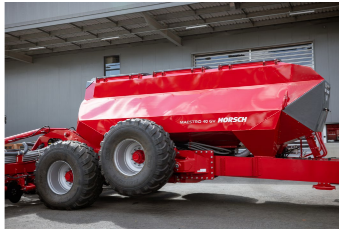
Tanque de sementes com capacidade de 9.700 litros
