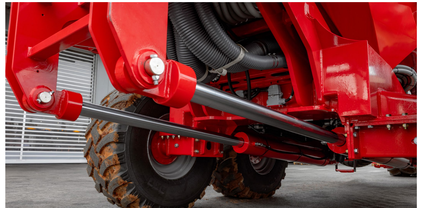
Sistema para transferência de peso
