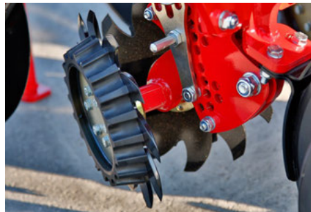
Optionale Räumsterne, schwimmend mit Tiefenführung
