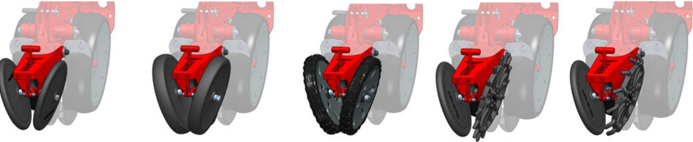
V-Druckrollen schmal: für normale Bedingungen V-Druckrollen breit: für leichtere Standorte V-Druckrollen breit, profiliert: für leichte Standorte und Feinsaaten (Rüben und Raps) Stachelrolle: für mittlere bis leichtere Bedingungen Fingerrolle: für mittlere bis schwere Bedingungen
