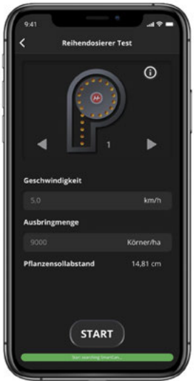
Mit Hilfe der App HORSCH Control kann jederzeit ein Test der wichtigsten Parameter der Vereinzelnungsqualität auf Einzelreihenbasis durchgeführt werden
