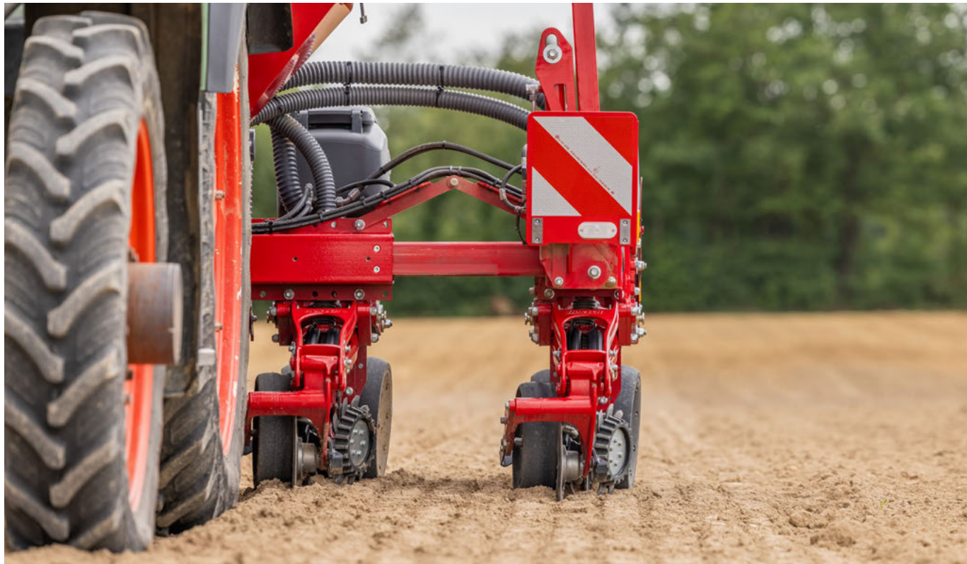
Kompakter Straßentransport dank teleskopierbarer Reihen
