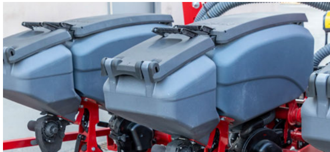
Mikrogranulatreihenbehälter mit 18 l Volumen
