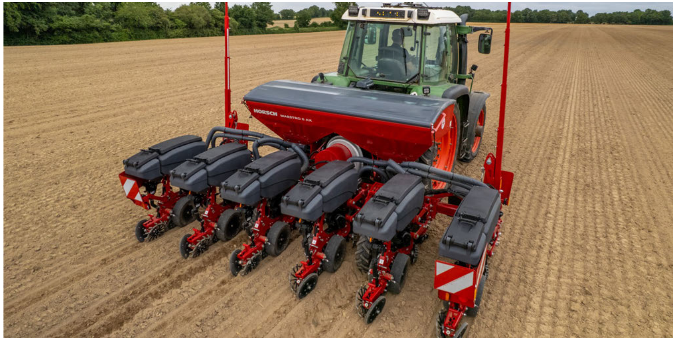
1 100 l Düngertank mit Halbseitenschaltung
