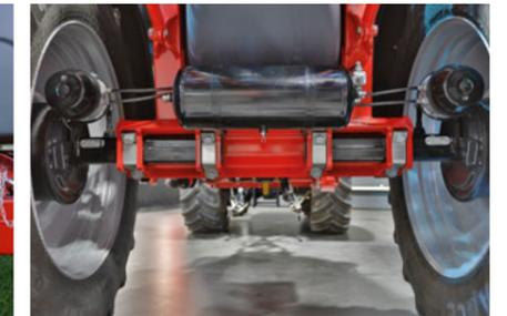
Steckachse für mechanische Verstellung der Spurweite je nach Bereifung von 1,50 bis 2,25 m
