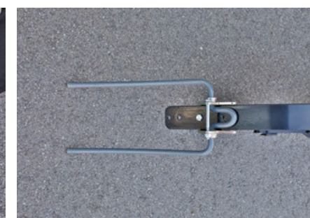
L'erpice diritto davanti al coltro di semina TurboDisc è regolato individualmente per una lavorazione del terreno più efficiente
