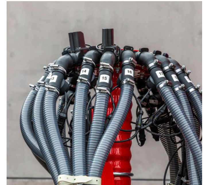
Controllo del flusso di fertilizzante e seme – per un monitoraggio continuo dei tubi di semina e fertilizzazione
