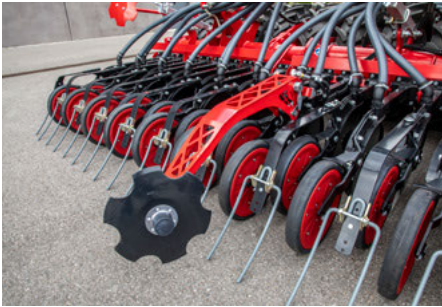
L’aggressività del marcatore pre-emergenza viene regolata tramite un arresto di profondità
