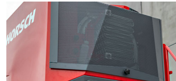
Raffreddamento dell'olio sul ventilatore idraulico – riscalda il flusso d'aria nel sistema pneumatico
