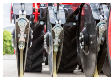
Il raschiatore mobile garantisce un'elevata autopulizia in condizioni di umidità
