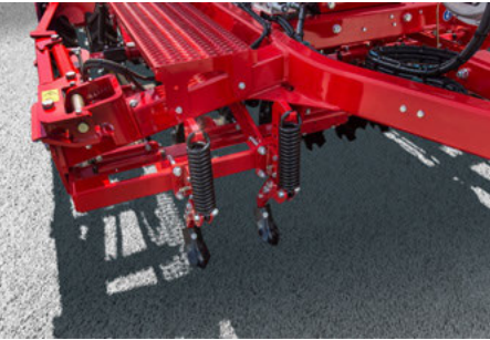
Denti di scarificatore a molla servono per allentare le compattezzazioni del suolo nella traccia del trattore.
