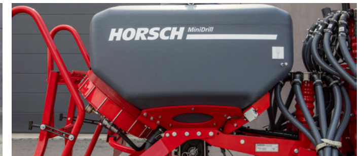
Le varianti MiniDrill Solo possiedono un proprio ventilatore, un proprio sistema pneumatico e un ulteriore orizzonte di deposito
