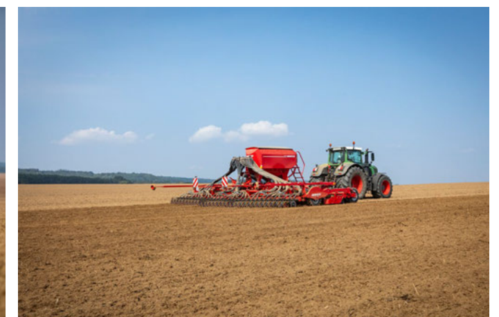
Opcjonalna wersja z dwoma głowicami rozdzielczymi umożliwia wyłączenie połowy szerokości roboczej
