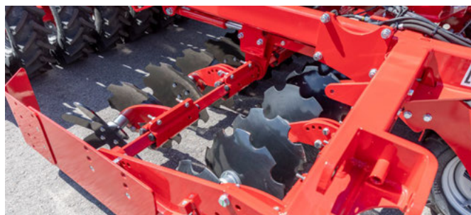
DiscSystem Pronto DC z dobudowanym uchwytem dla talerzy spulchniających ślady
